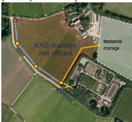
Figuur 5 Sub infiltratie van RWZI effluent in Haaksbergen.
