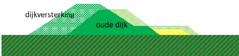
Figuur 7 Kleidijk buitenwaarts versterkt met klei eventueel met vergraven oude dijk en binnenberm
