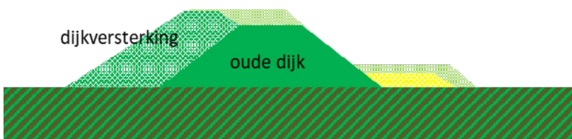
Figuur 6 Kleidijk buitenwaarts versterkt met klei eventueel met verhoging kruin en of binnenberm
