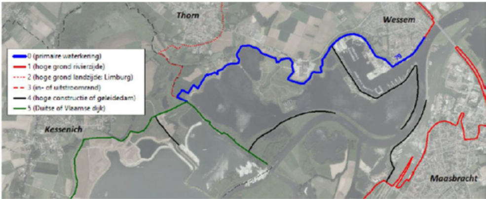
Figuur 3 Voorbeeld in de Limburgse Maas met strekdammen (zwart), welke niet in de bepaling van de golfcondities zijn meegenomen.
