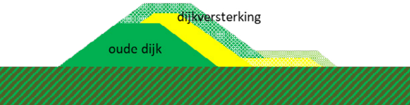
Figuur 4 Kleidijk binnenwaarts versterkt met zand (eventueel met binnenberm)
