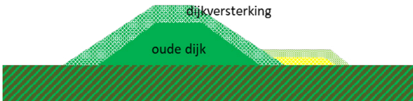
Figuur 3 Kleidijk versterkt met klei (eventueel met binnen berm)
