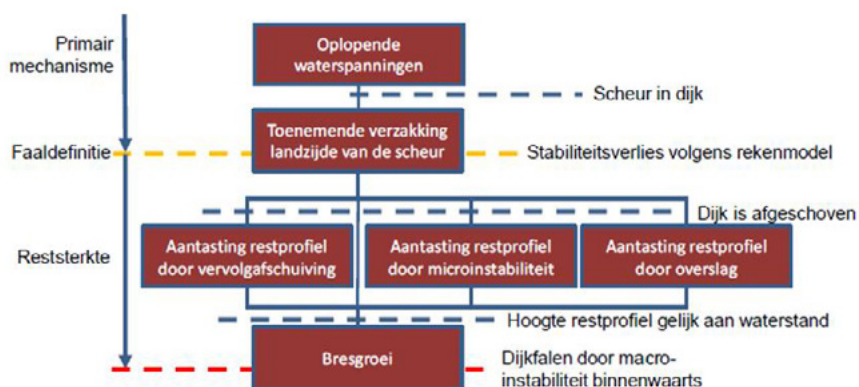
Figuur 1 Gebeurtenissen leiden tot falen van de dijk na macro-instabiliteit [2]
