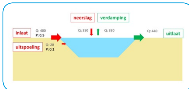
Figuur 2: Overzicht belangrijkste water- en stofstromen Kardingerplas. P: P-belasting in \text{mg}/\text{m}^2/\text{d} , Q: debiet in \text{m}^3/\text{dag} .
