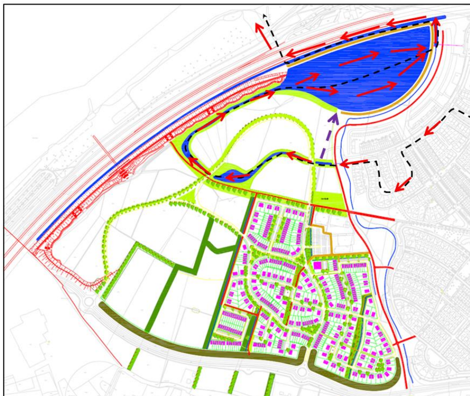
Figuur 3.2 | Plattegrond Harderweide in Harderwijk (stromingsrichting rode pijlen) (bron: gemeente Harderwijk, persoonlijke communicatie, 24 november 2017).
