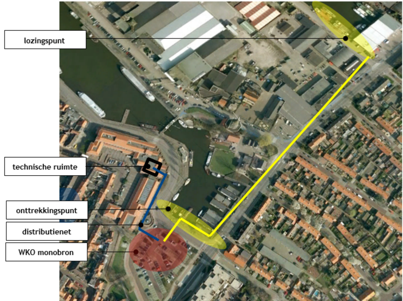
Figuur 11 | Schetsontwerp WKO + TEO systeem voor het stadhuis in Harderwijk met het 2 pijps-distributienet (blauwe leidingen). WKO zoekgebied monobron (rood), TEO systeem (geel), technische ruimte (zwart, niet op ware grootte). Het leidingwerk en locatie TEO en WKO systeem zijn indicatief om een inschatting van de totale lengte en kosten te kunnen doen.
