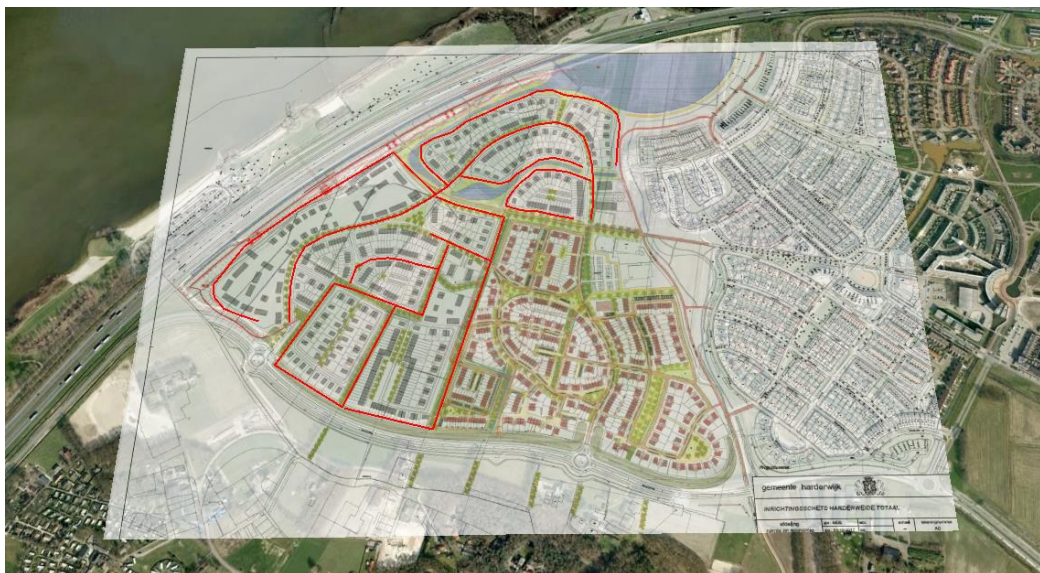
Figuur 4.4 | Schetsontwerp WKO + TEO systeem voor Harderweide in Harderwijk met het 2 pijps-distributienet (rode leidingen). Het leidingwerk is indicatief om een inschatting van de totale lengte te kunnen doen. De inrichtingsschets van Harderweide is gebruikt als beeldoverlay in Google Earth.
