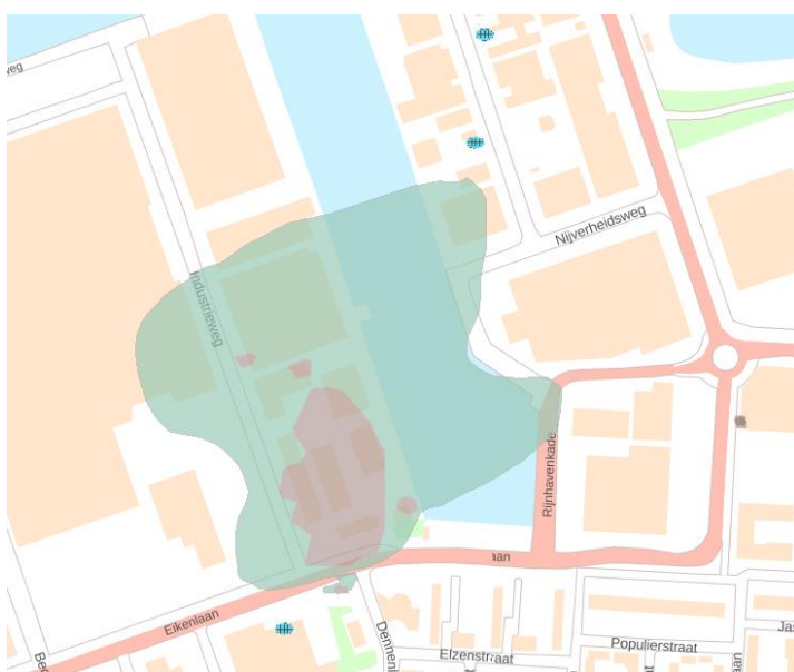
Figuur 3.9 | Grondwaterverontreiniging nabij Baronie Haven. Het betreft een verontreiniging met VOC's, minerale olie en aromaten tot aan de eerste scheidende laag. Er heeft een sanering plaatsgevonden.
