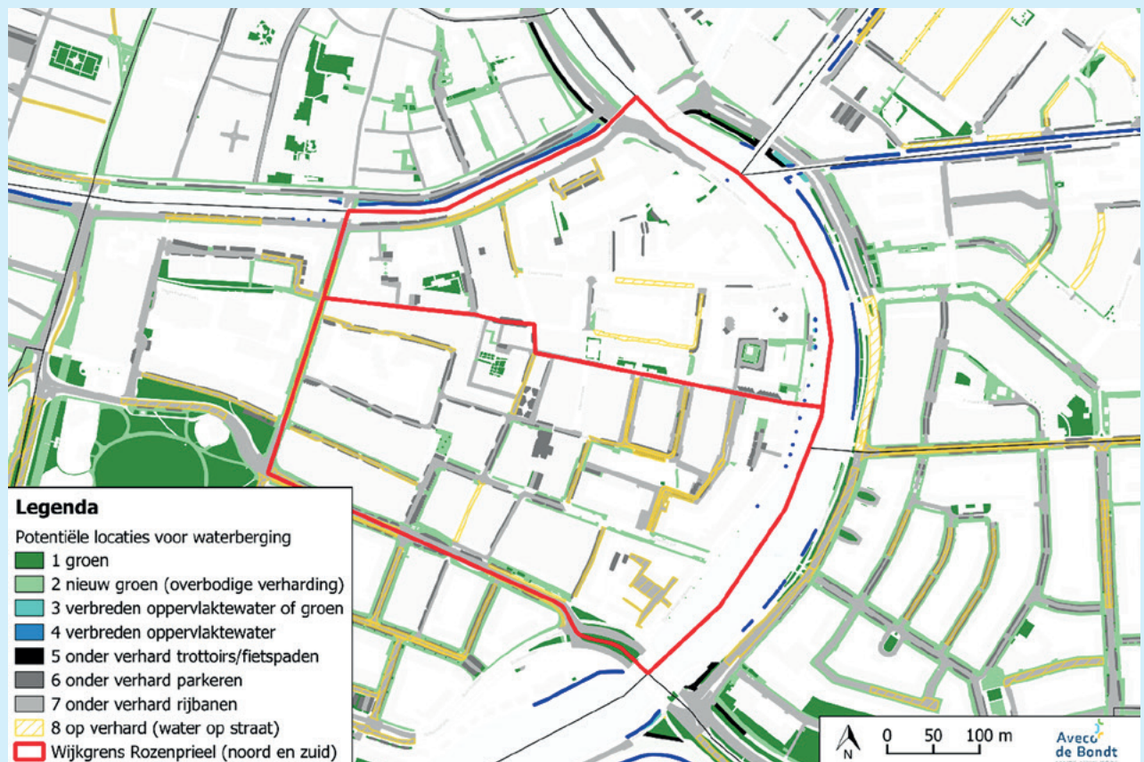
Figuur 1: Beschikbare locaties voor het tijdelijk bergen van regenwater in de stad Haarlem, ingezoomd op de wijk Rozenprieel. In een oude wijk zoals het Rozenprieel is vaak relatief weinig groen aanwezig, waardoor waterberging voornamelijk onder of op de wegen moet worden ingepast. Met name in het Rozenprieel Noord is zelfs onder de wegen de ruimte beperkt vanwege hoge grondwaterstanden.
