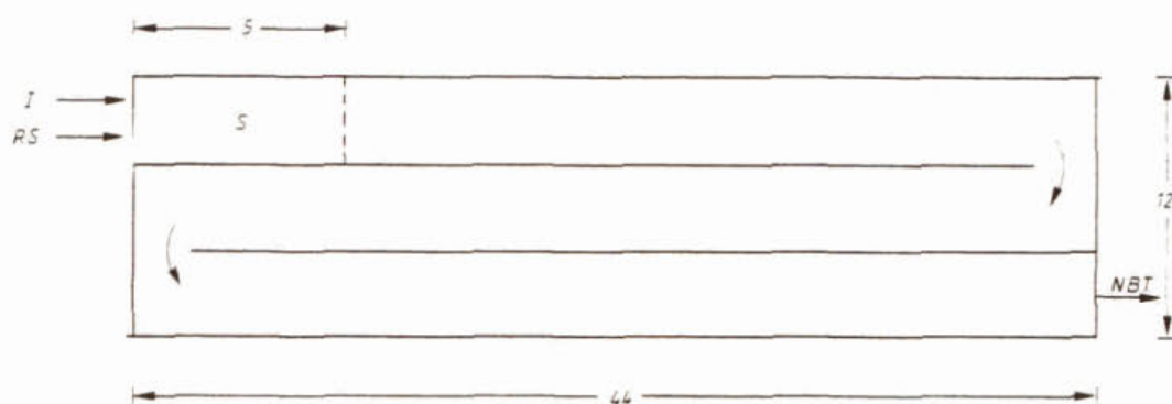
Figuur C.5 Beluchtingsruimte plus selector in de rwzi Dongemond.
