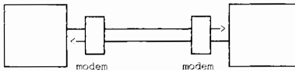
Figuur 4.7 Verbinding door tussenkomst van modems
