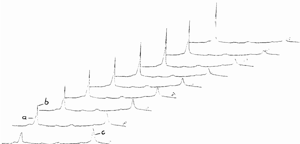
Figuur 11 ^{31}\text{P} -NMR spectra van F&D-slib. Elk spectrum is een gemiddelde van 1 uur meten. Het eerste spectrum is 1 uur na de start gemaakt, de laatste is na 17 uur opgenomen. Piekidentificatie: a. intern orthofosfaat; b. extern orthofosfaat; c. polyfosfaat.
