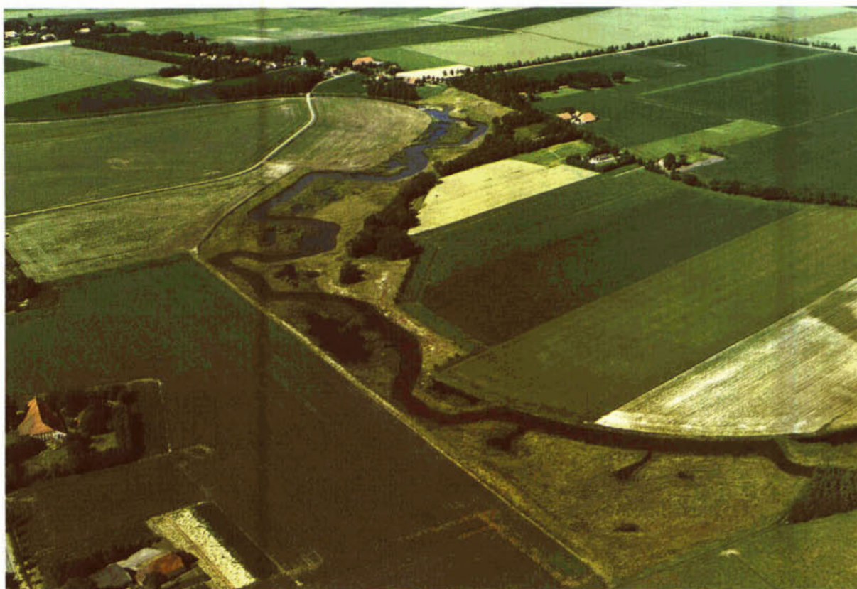
Toename ruimtebeslag na het graven van meanders
