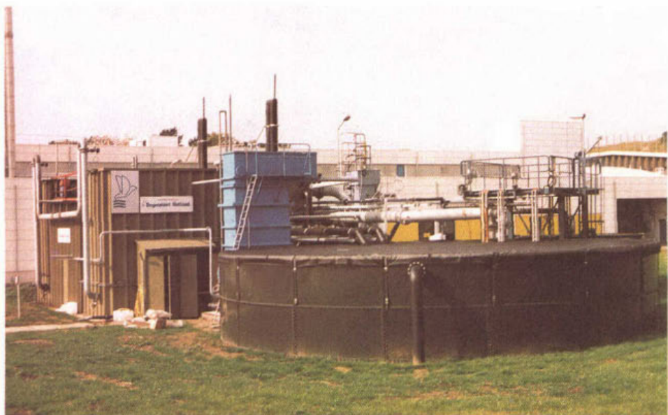
Proefinstallaties op de rwzi Utrecht voor het strippen en precipiteren van ammoniak uit stikstofrijke retourstromen. Deze onderzoeken zijn beschreven in de STOWA-rapporten 95-8 tot en met 95-15.
