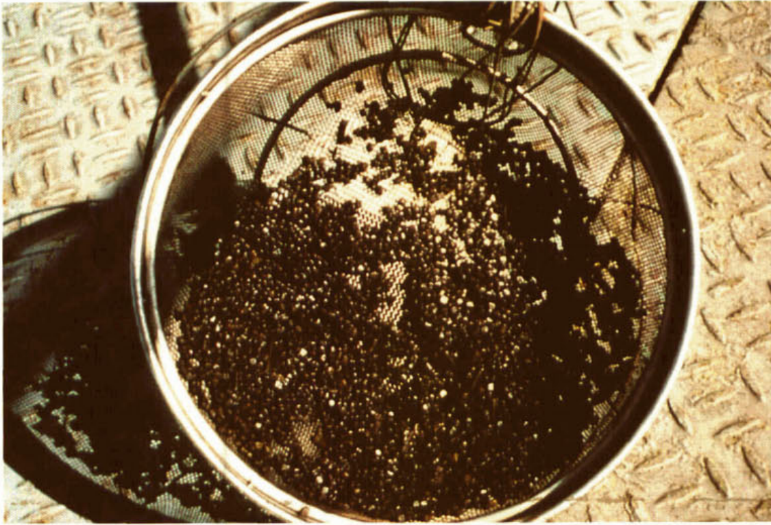
Figuur 1.5: Polyethyleenglycol deeltjes uit de demonstratiereactor met daarin geïmmobiliseerd nitrificerend slib.
