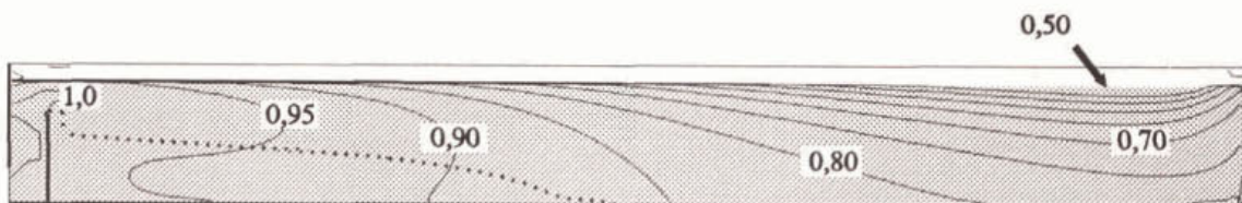
Figuur 9: Relatieve concentratiecontourlijnen (instroomconcentratie = 1,0 ) van deeltjes met een valsnelheid van 5,4 \text{ m/h} .
