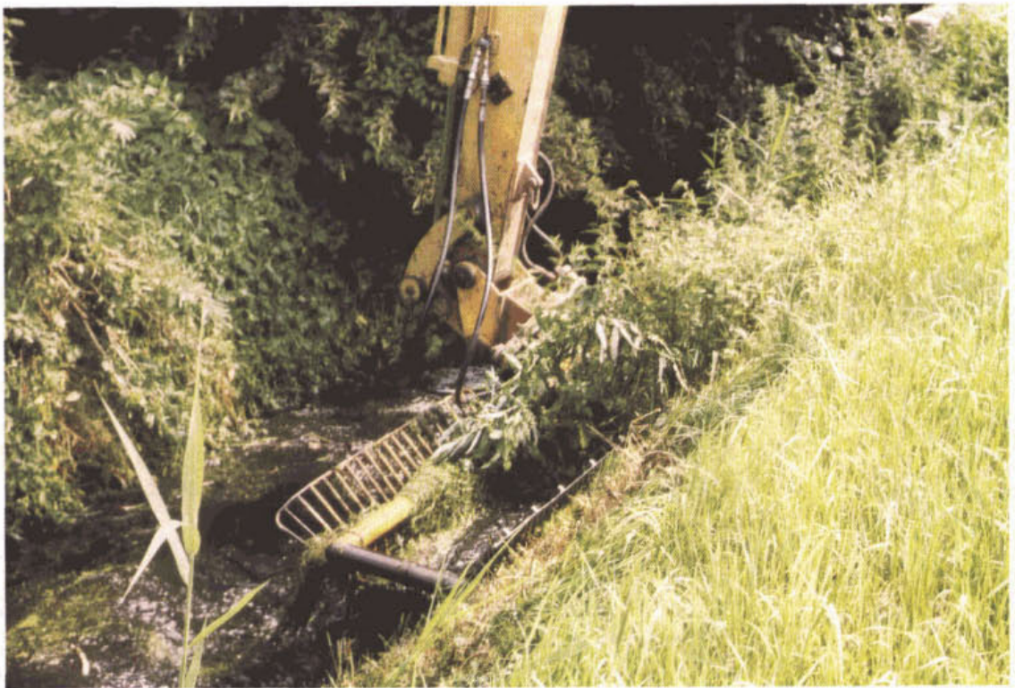
Foto 2: Eenzijdig maaien met maaikorf
