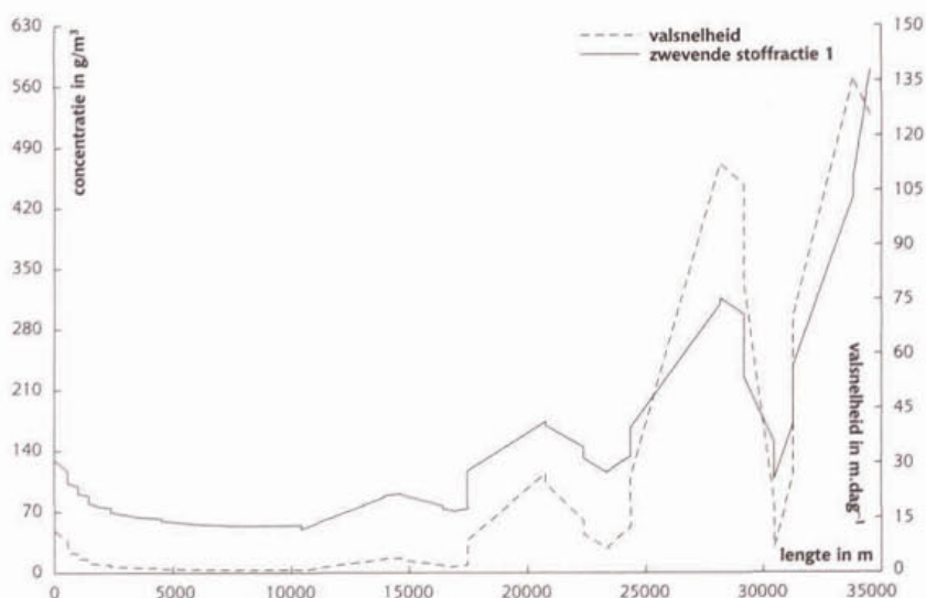
Figuur 4.3 Concentratie zwevende stof SS1 en valsnelheid als functie van de afstand
