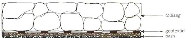
Abbeelding 4.4 Opbouw filter met geotextiel.
