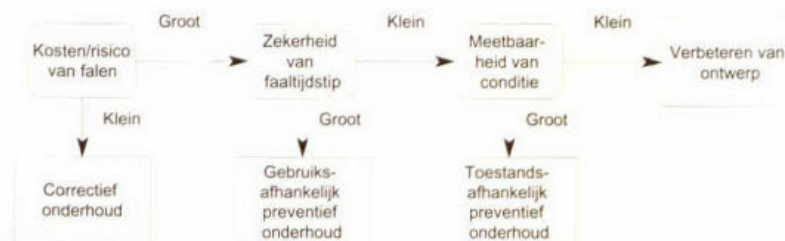
Figuur 4.1 beslissingsdiagram voor correctief en preventief onderhoud [Van Noordwijk, 1996]
