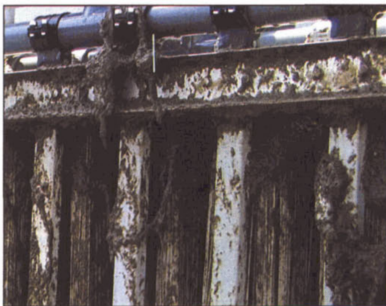
Afbeelding 2 - Macro-vervuiling van een membraan
