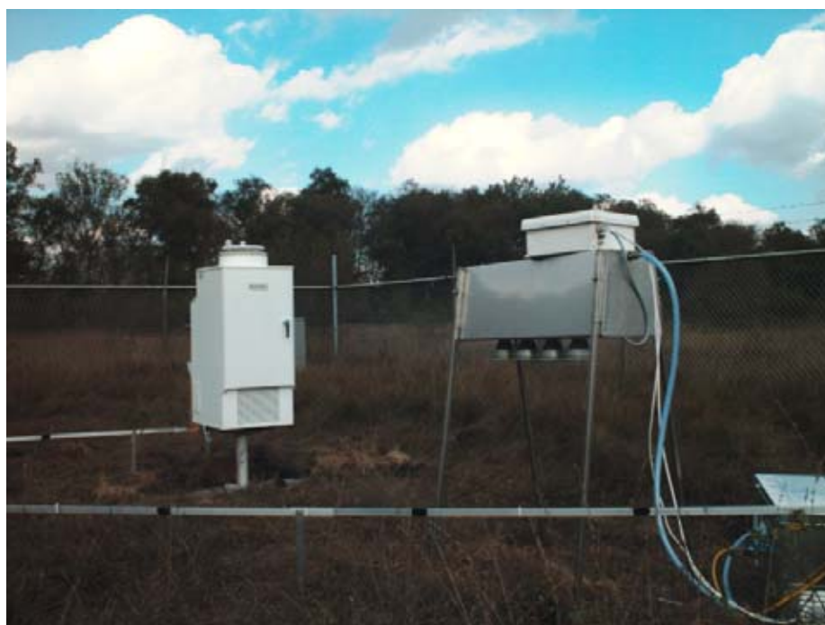
Figuur 2 Neerslagvanger en apparatuur voor het nemen van luchtmonsters op de locatie Speulderveld.
