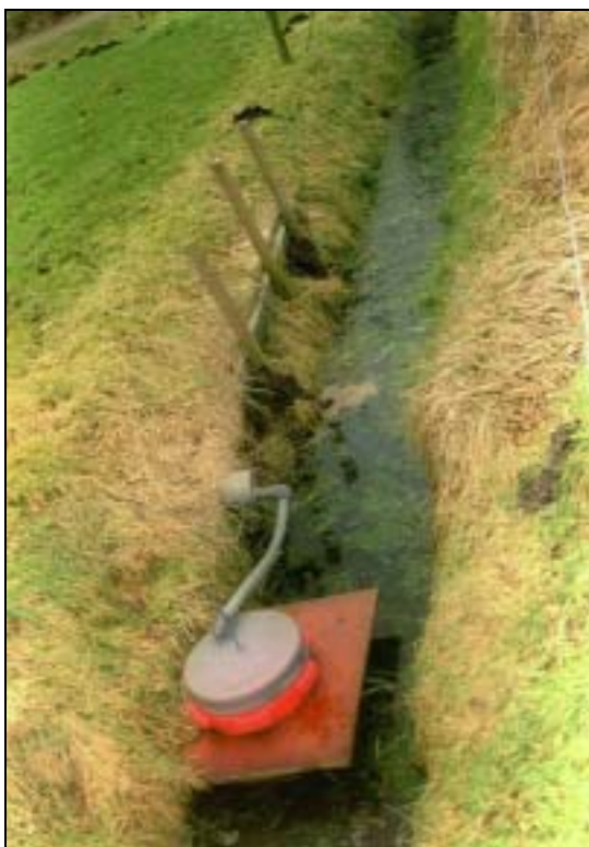
AFBEELDING 5.3 MEETGOOT VOOR ANALYSE VAN DE RUN-OFF
