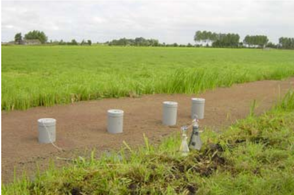
OPSTELLING DENITRIFICATIEMETINGEN IN DE PROEFSLOOT (AIT)
