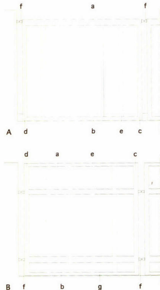
197. Schema van de hoofdconstructie van een stalen deur als stijldeur: (A) normale uitvoering, (B) met hooggelegen onderregel en laaggelegen bovenregel.
