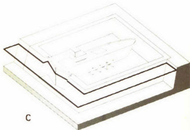
354. Doksluis: (A) open, (B) legen bij laagwater en (C) kerend. a = droogdok, b = doksluis, c = schip.
