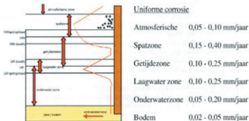
AFBEELDING 3 GEMIDDELDE CORROSIESNELHEID (HANDBOEK KADEMUREN)
