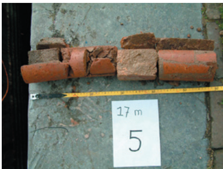
AFBEELDING 35 BOORKERNEN UIT GEMETSELDE WAND KADEMUUR ZIERIKZEE
