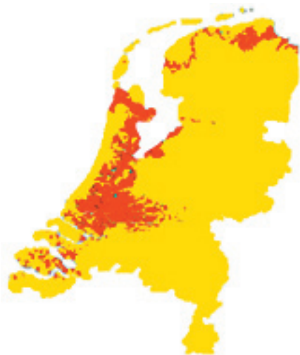
AFBEELDING 15 DE BEKENDE RISICOVOLLE GEBIEDEN BACTERIËLE AANTASTING PAALFUNDERING (AFBEELDING VAN STICHTING HOUT RESEARCH (SHR)) EN AANGETASTE EN GEKNAKTE PAAL (FOTO VAN FUGRO INGENIEURSBUREAU BV)
