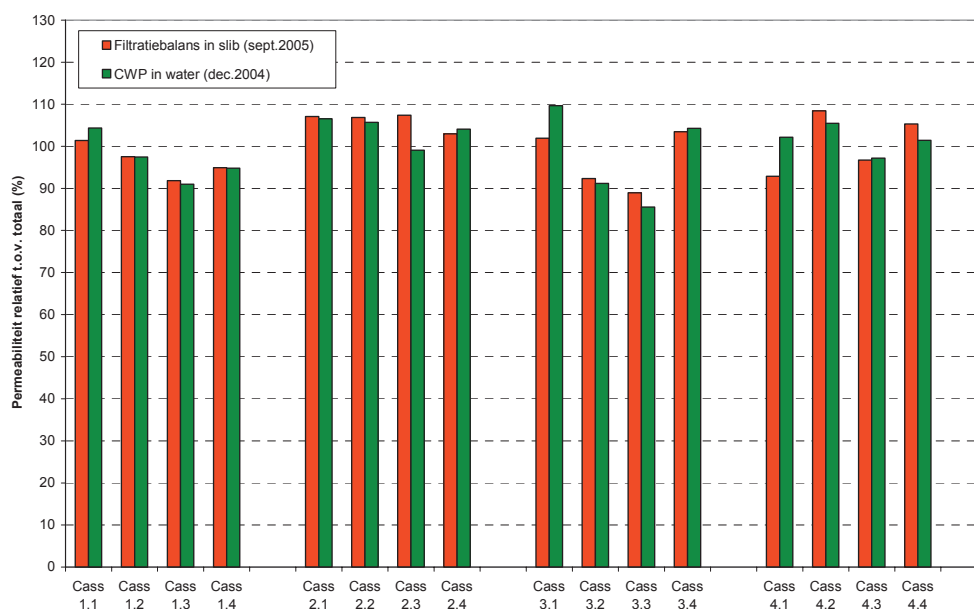
AFBEELDING 28 PERMEABILITEIT (RELATIEF) PER CASSETTE BIJ DE CWP- EN FILTRATIEBALANS METINGEN
