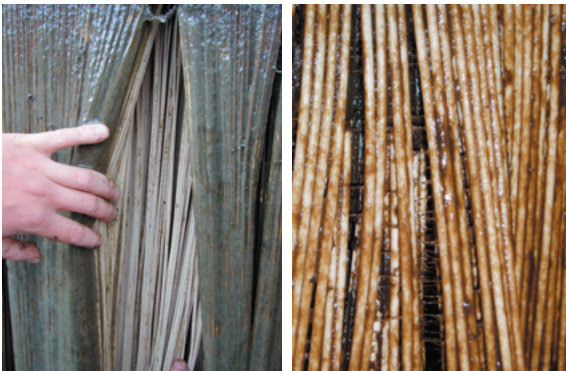
AFBEELDING 23 SLIJMLAAG ROND DE MEMBRANEN BIJ EXPERIMENT ÉÉN (LINKS) EN EXPERIMENT TWEE (RECHTS)
