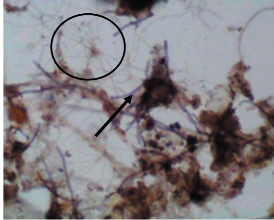
(1000x) Neiserkleuring, Type 0092 (pijl) en niet gekleurde type 0581 draden (cirkel). Weinig polyfosfaat in granulevorm in de vlok aanwezig.
