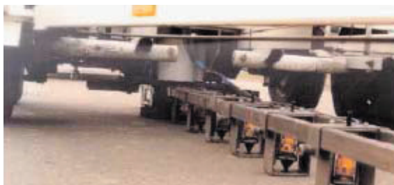
FIGUUR B5.5 VALGEWICHT-DEFLECTIEMETER: MEETBALK MET GEOFOONS (FOTO: NPC)
