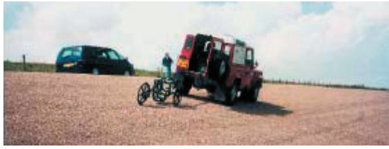
FIGUUR B5.3 BEPALING VAN DE LAAGDIKTE MET BEHULP VAN RADARMETING
