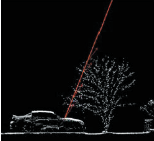
FIGUUR 5.18 MEERDERE RETURNS PER PULS VOOR LASERALTIMETRIE (BRON FLI-MAP)
