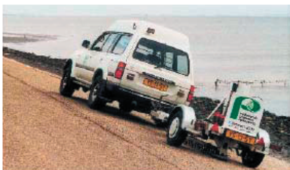
FIGUUR B5.5 VALGEWICHT-DEFLECTIEMETER: MEETBALK MET GEOFOONS (FOTO: NPC)
