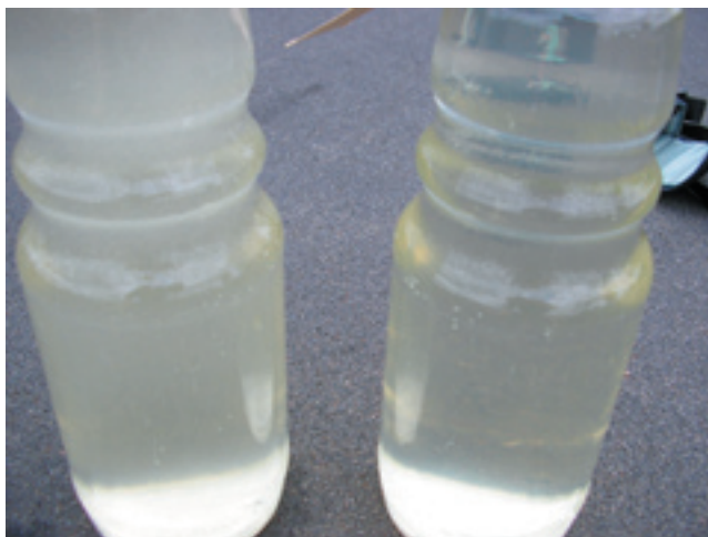
LINKS EEN MONSTER VOOR FILTRATIE, RECHTS NA FILTRATIE MET HET FUZZY FILTER
