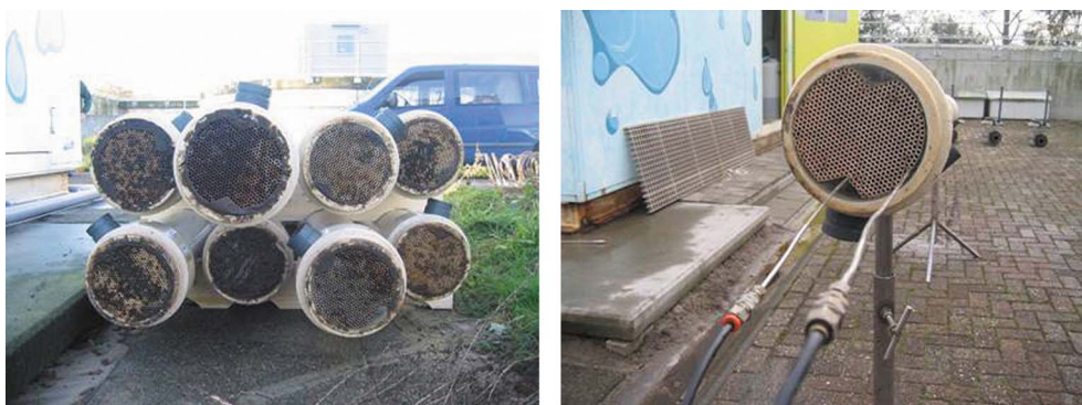
FIGUUR 42: VERSTOPTE GAATJES IN BELUCHTINGSCHOTELS VAN DE MEMBRANEN
