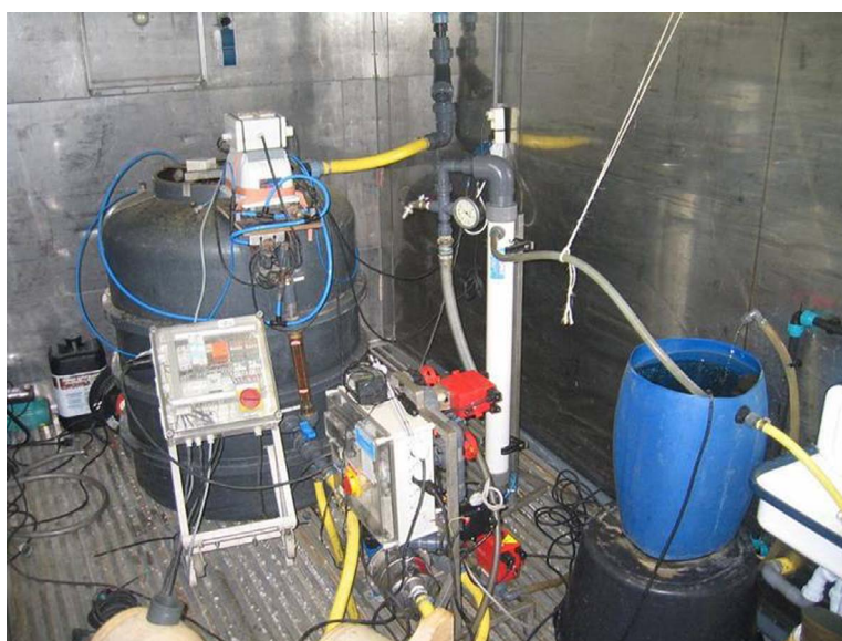
FIGUUR 8: OPSTELLING MBR KWEEKINSTALLATIE OP RWZI LEEUWARDEN IN CONTAINER
