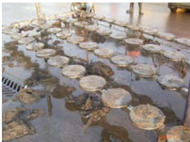
AFBEELDING V.8.3 SPINSEL IN DE BELUCHTING
