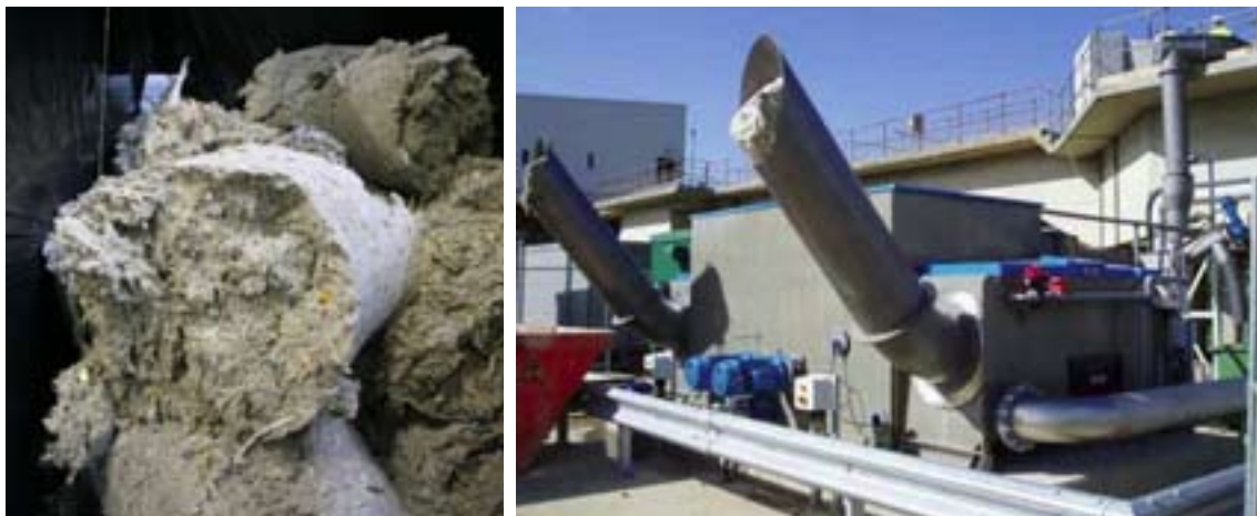
AFBEELDING 15 GEPERST ROOSTERGOED [11] EN ROOSTERGOEDPERS
