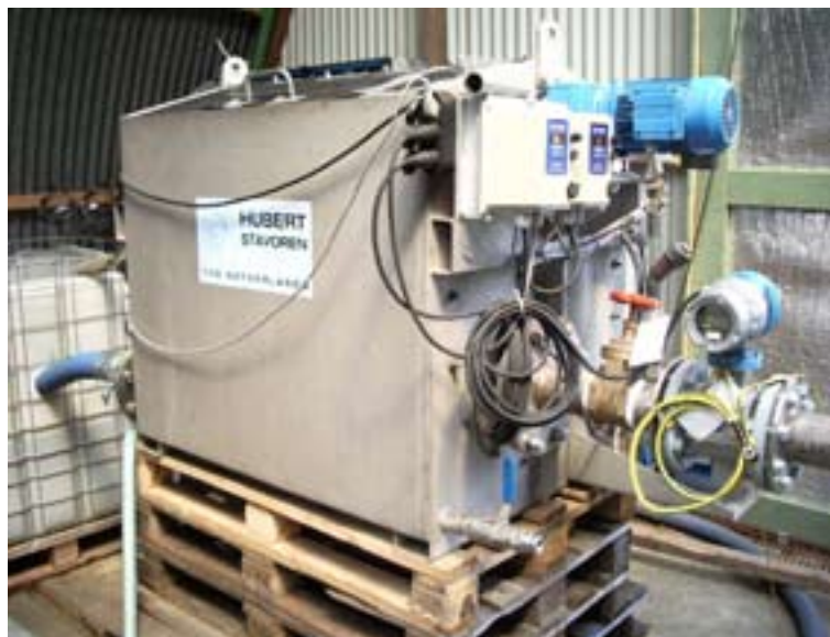
AFBEELDING 27 ZEEFBOCHT EN MICROZEEF ALS VOORBEHANDELING MULTIMEDIAFILTER (HORSTERMEER)
