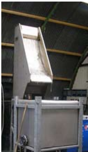
AFBEELDING 27 ZEEFBOCHT EN MICROZEEF ALS VOORBEHANDELING MULTIMEDIAFILTER (HORSTERMEER)
