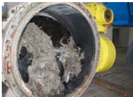
Door doekjes en vezels verstopte vlinderklep
