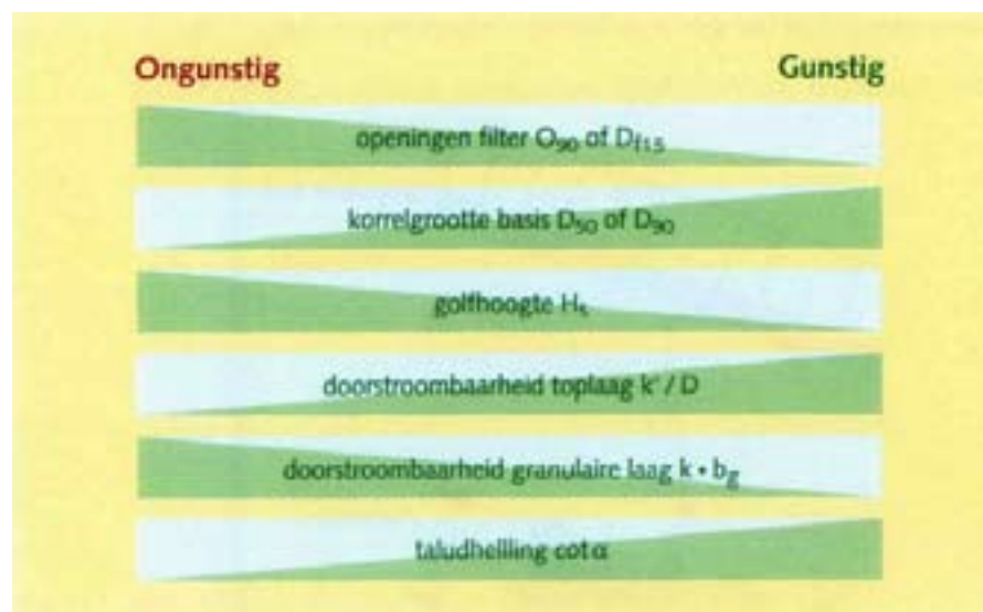
PARAMETERS MATERIAALTRANSPORT ONDERGROND &gt; GRANULAIRE LAAG
