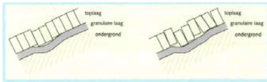
SCHADEVERLOOP BIJ FAALMECHANISME MATERIAALTRANSPORT VANUIT DE ONDERGROND
