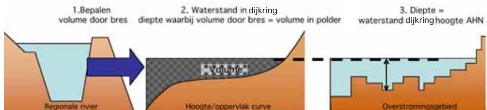
FIGUUR 3-9 BEPALEN OVERSTROMINGSDIEPTE MET BEHULP VAN EEN BAKJESMODEL
