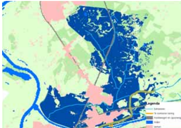
FIGUUR 3-8 VOORBEELD GEBIED DAT THEORETISCH KAN ONDERLOPEN BIJ DE MAXIMUM WATERSTAND (MAAIVELD IS LAGER DAN WATERSTAND). IN WERKELIJKHEID ZAL HET GEBIED KLEINER ZIJN OMDAT DE INSTROOM DUUR BEPERKT IS
