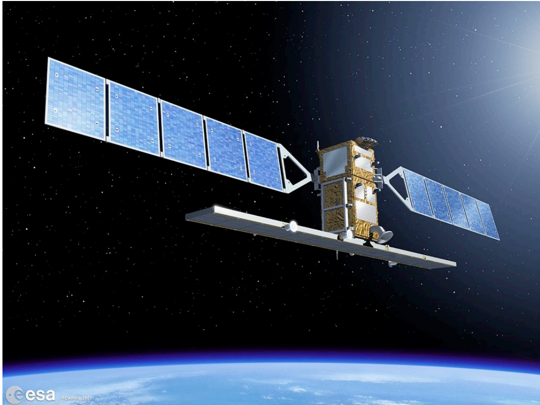
figuur 13 De Sentinel-1, de eerste satelliet speciaal gebouwd voor het Europese programma voor monitoring ten behoeve van milieu en veiligheid (GMES). Deze moet in 2011 worden gelanceerd. (© ESA – P. Carril)
