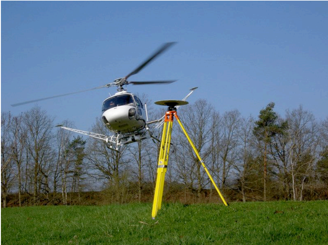
figuur 16 Een helikopter met het laseraltimetriesysteem in een rek. Twee GPS-ontvangers op masten aan weerszijden zorgen voor een betere positie- en standbepaling. Het GPS-baisstation op de grond zorgt voor een differentiële positiebepaling. (© Fugro-Inpark)
