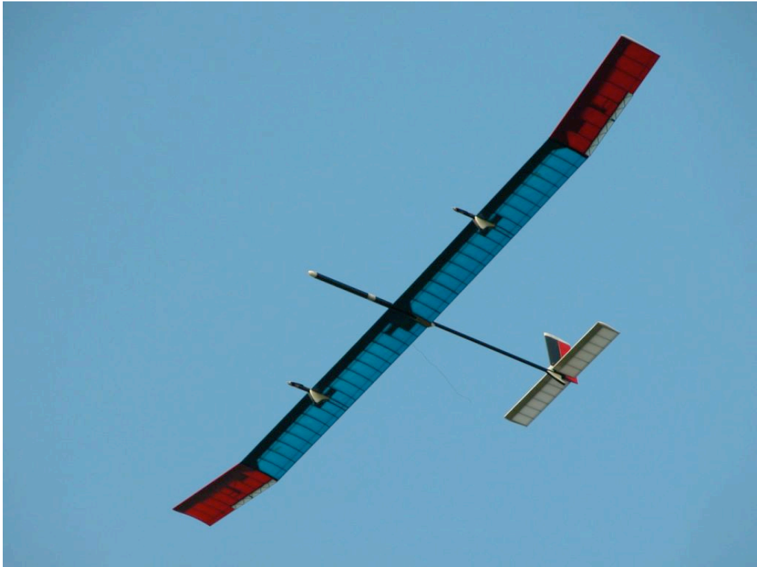
figuur 23 Een prototype van het langdurig hoogvliegende onbemande vliegtuig MERCATOR, met een spanwijdte van 18 meter en een gewicht van 32 kg, maakt een proefvlucht. De instrumenten komen in de buis voorop en mogen niet meer dan 2 kg wegen. (© VITO)
