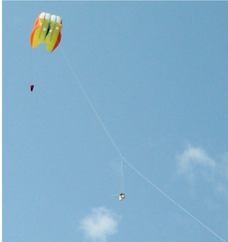
figuur 21 Een parafoil heeft een grote stabiliteit en draagvermogen en geen frame. Een luchtanker zorgt voor extra stabiliteit. De camera is radiografisch bedienbaar. (© Merryl Martin Owen)
