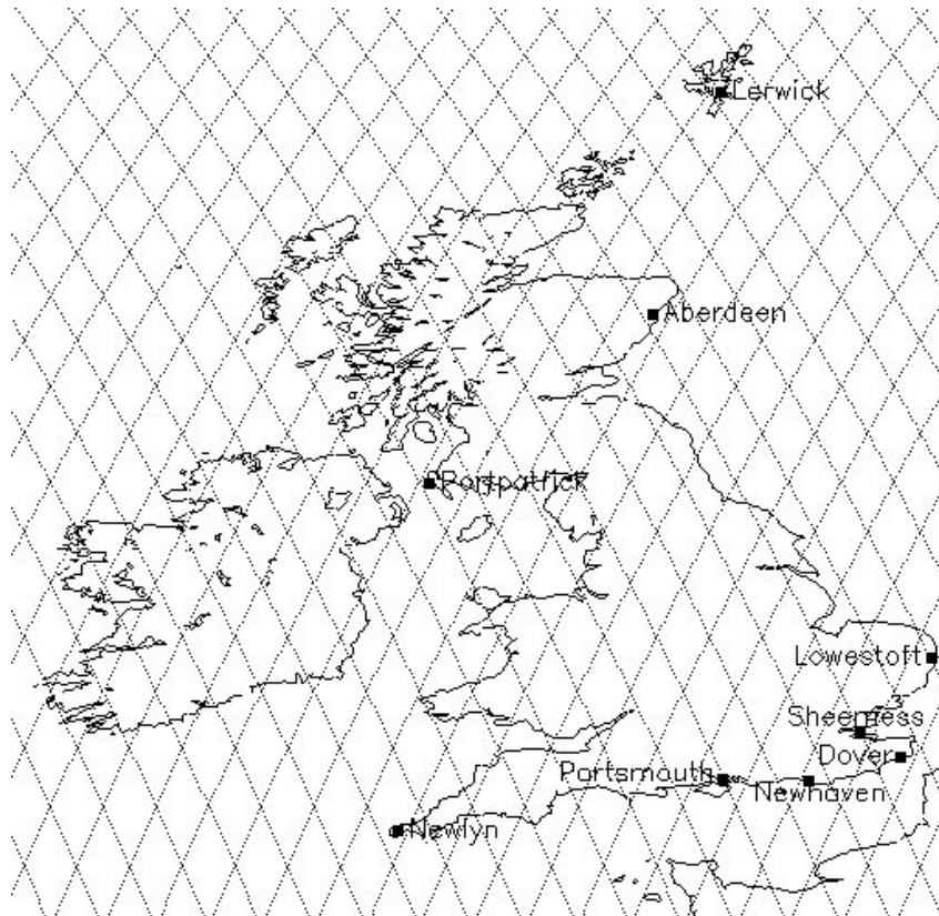
figuur 10 Een satelliet kent een vast patroon van waar hij over het aardoppervlak passeert. Daarbij is het patroon ofwel dicht maar de overkomstfrequentie laag, ofwel ijl maar de overkomstfrequentie hoog. Hierboven het spoor van de ERS, die eens per 35 dagen zijn baan herhaalt.
