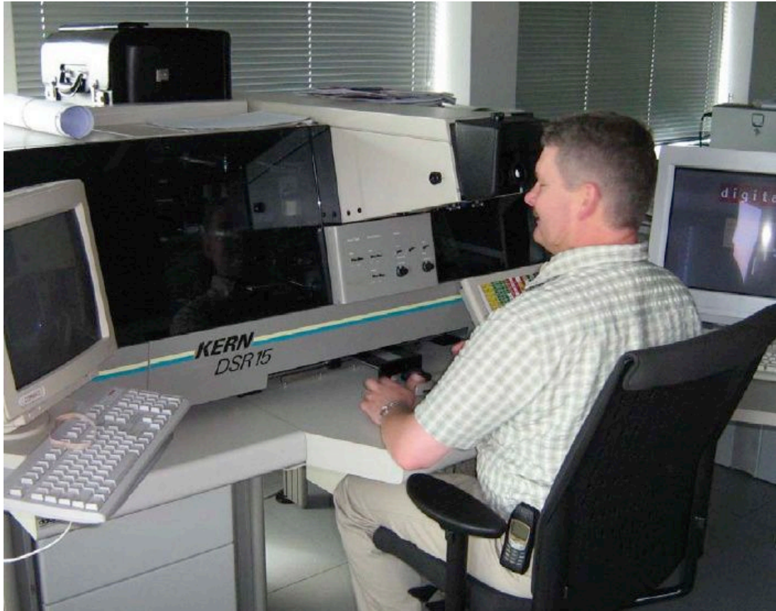
figuur 30 Een operateur bezig met het uitwerking van een fotogrammetrische opname in een analoog uitwerkingsinstrument. (© Rijkswaterstaat Adviesdienst Geo-informatie en ICT)
