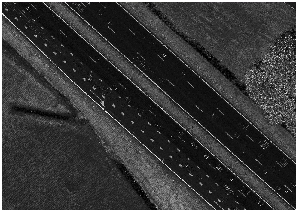
figuur 44 Van de intensiteit van de reflectie van elk individueel laserpuntje kan een intensiteitsbeeld worden vervaardigd. Een dergelijk beeld kan helpen bij de uitvoering van de kartering omdat deze exact dezelfde data laat zien als het hoogtemodel. (© Fugro Inpark, FLI-MAP 400).
