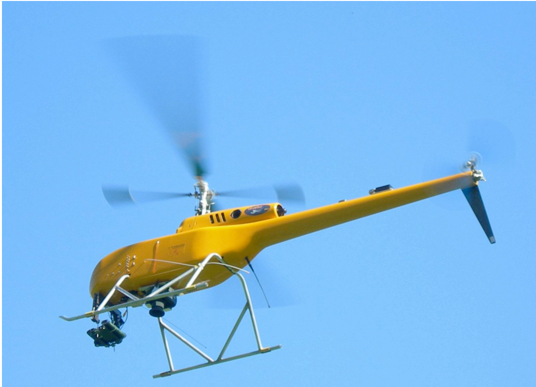
figuur 22 De onbemande helikopter van E-producties en Miramap, waarmee van lage hoogte snel gedetailleerde beelden kunnen worden gemaakt. (© Miramap)
