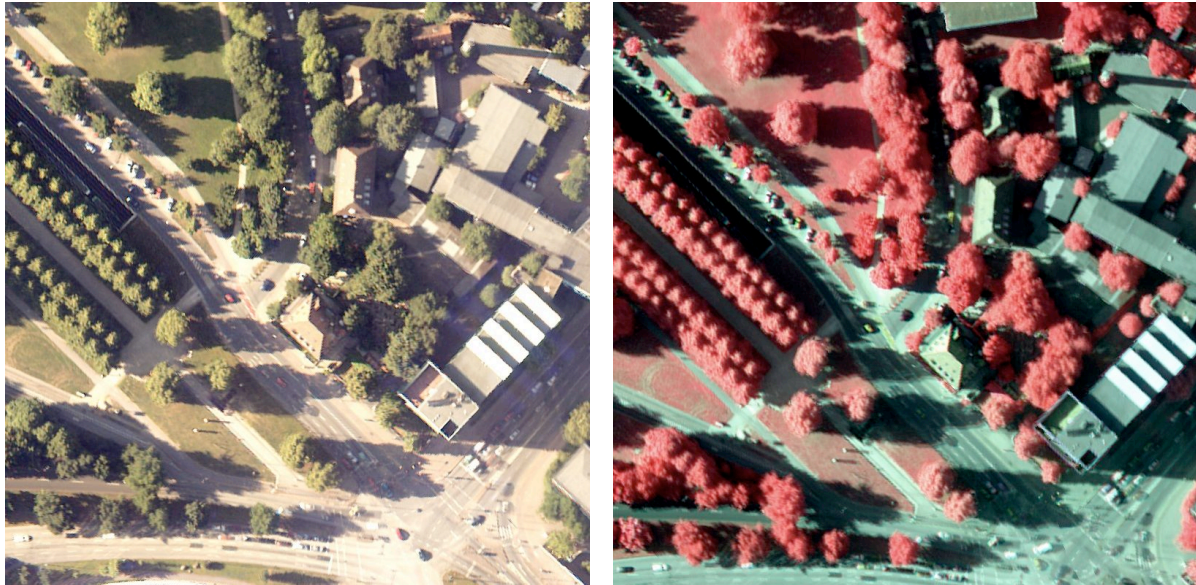
figuur 33 Rechts een typisch kleureninfraroodbeeld, overeenkomend met het gewone RGB-beeld links. In een kleureninfraroodbeeld (CIR) is het infrarode kanaal toegekend aan het rood. Gezonde vegetatie reflecteert nabij-infrarood sterk, minder gezonde vegetatie is fletsrood tot blauwgrijs. (© TopoSys)
