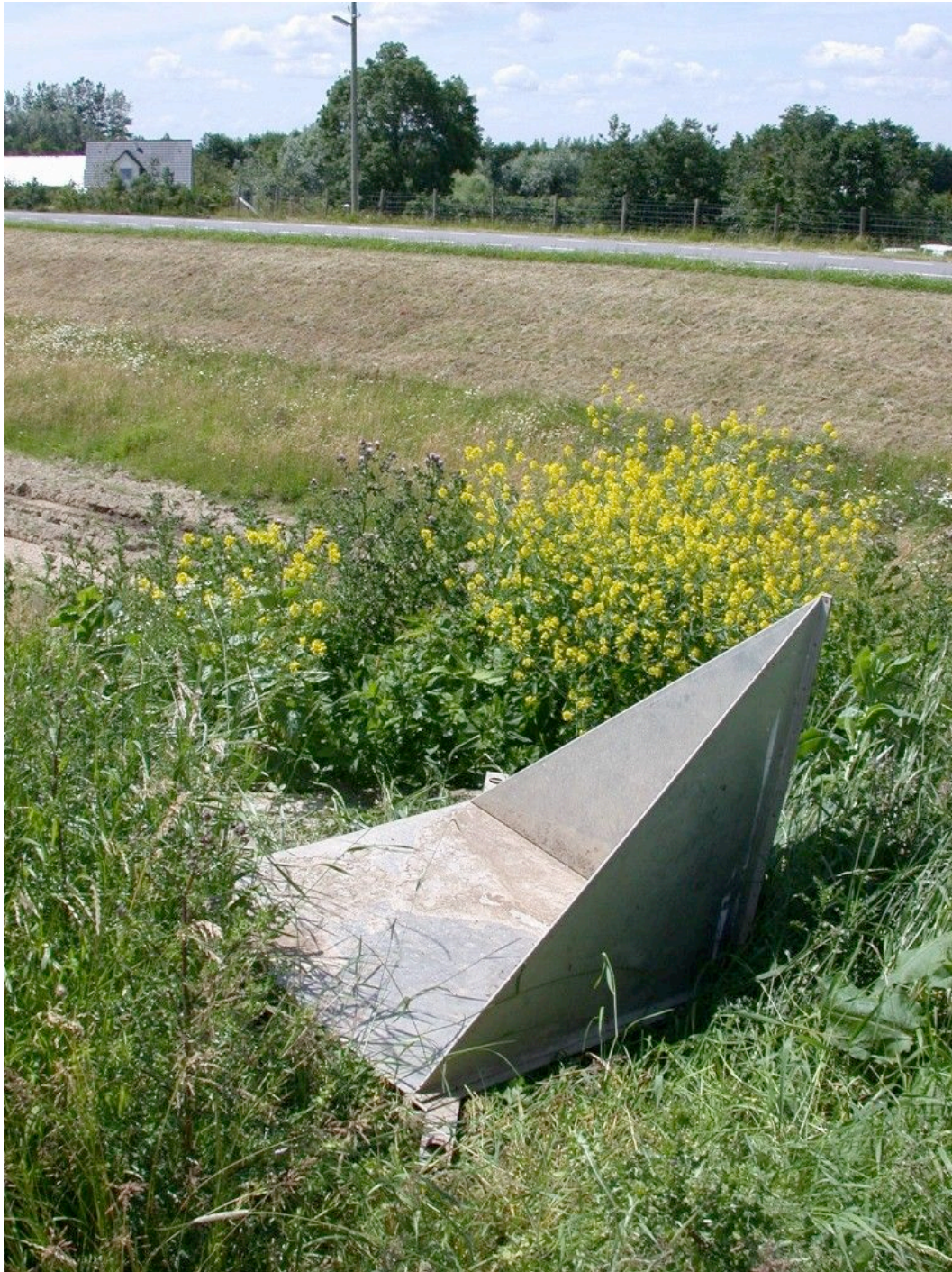
figuur 56 Een aluminium hoekreflector kan dienen als kunstmatige langcoherente verstrooier of persistent scatterer, om zo het gebrek aan natuurlijke reflectiepunten in het terrein te compenseren. Deze moeten jaren verankerd blijven en zeer constant van vorm zijn – en koebestendig ... Dit is een van de reflectoren die bij de proef bij de Lekdijk bij Bergambacht is gebruikt. (© Swartvast – Rens Swart)
