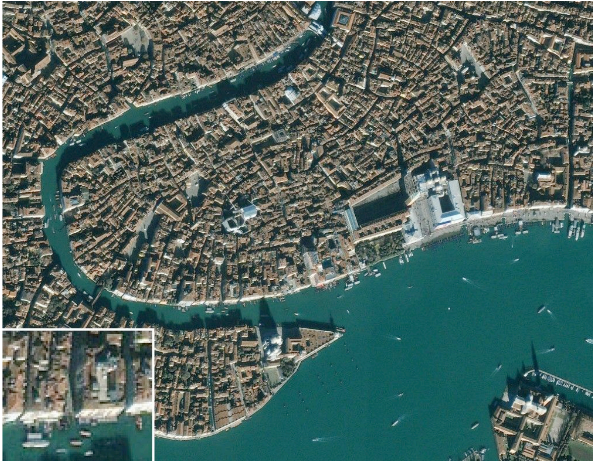
figuur 32 Een IKONOS-beeld van Venetië met een resolutie van 1 meter (panchromatisch verscherpt kleurenbeeld) met linksonder een uitsnede driemaal vergroot. (© GeoEye)
