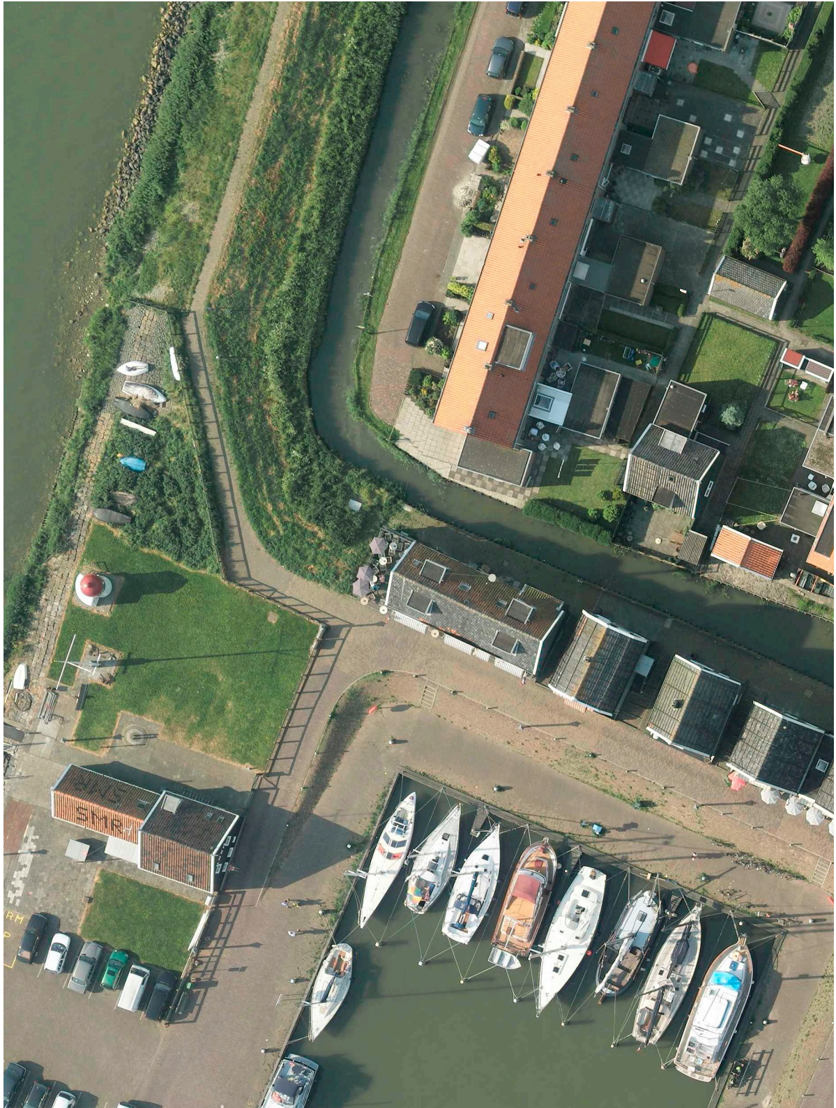
figuur 26 Voorbeeld van een luchtfoto met 4 cm resolutie: de haven van Marken. Deze is hierboven op de voor drukwerk maximaal zinvolle 300 pixels per inch afgebeeld. Zie ook de uitsnede in figuur 27. (© Aerodata International Surveys)
