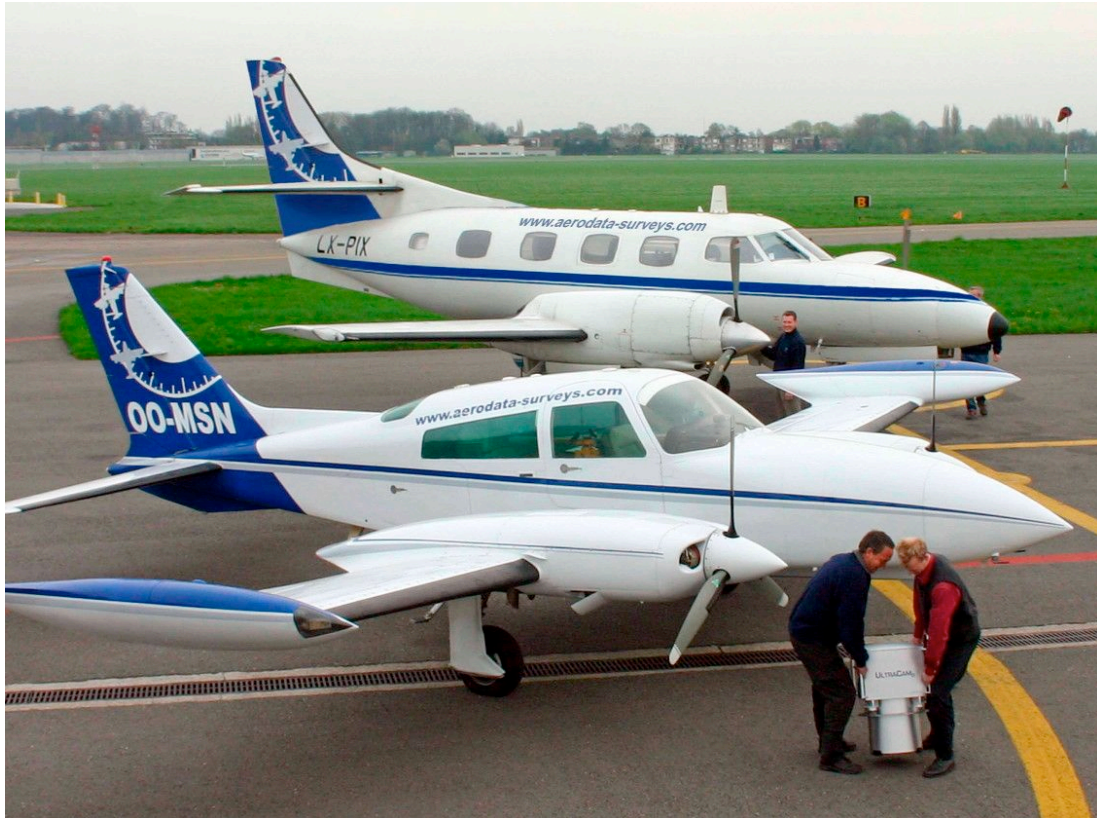
figuur 14 Tweemotorige waarneemvliegtuigen; op de voorgrond een Fairchild Merlin IIIA, een turboprop. De heren sjouwen een Vexcel UltraCam-D digitale fotogrammetrische camera. (© Aerodata International Surveys)
