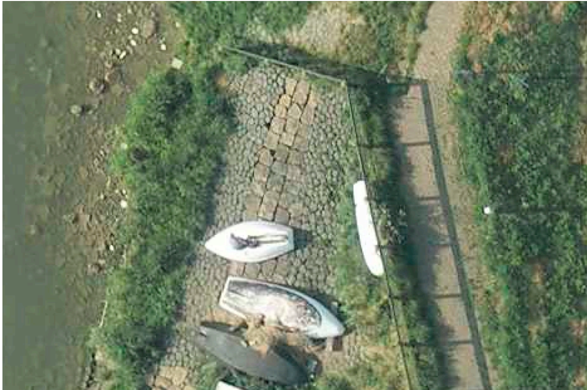
figuur 27 Een detail van de luchtfoto uit figuur 26 met een resolutie van 4 cm, viermaal vergroot tot 75 ppi (29,5 pixels/cm), geeft een indicatie van wat bij deze resolutie nog zichtbaar is. De jpeg-compressie-artefacten overheersen de beeldruis; dergelijke beelden kunnen ook minder sterk gecomprimeerd worden, waardoor de netwerk- en opslagvereisten navenant hoger worden. (© Aerodata International Surveys)
