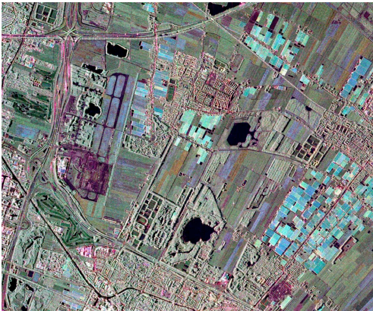
figuur 50 Een SAR-beeld van Ypenburg gemaakt met het PHARUS-instrument van onder een vliegtuig. Pixelgrootte 4 \times 4 meter, 5 looks. De kleuren zijn toegekend aan de hand van de polarisaties: R = HH, G = HV, B = VV. (© TNO Defensie en Veiligheid)
