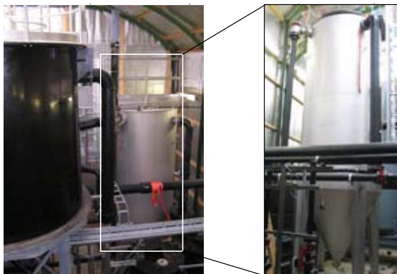
AFBEELDING 11 VLOKVORMINGSTANK (ZWART OP VOORGROND) EN CONTINU ZANDFILTER (RECHTS IN DETAIL) IN ONDERZOEKSSTRAAT A
