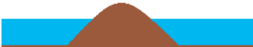
Figuur 7: Schematische voorstelling van een lokale verondieping die leidt tot de vorming van een klein eiland in een ondiep meer.
