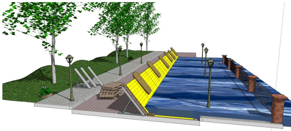
FIGUUR A1.7 VOORBEELD VAN EEN VRIJSTAAND KEERMIDDEL
