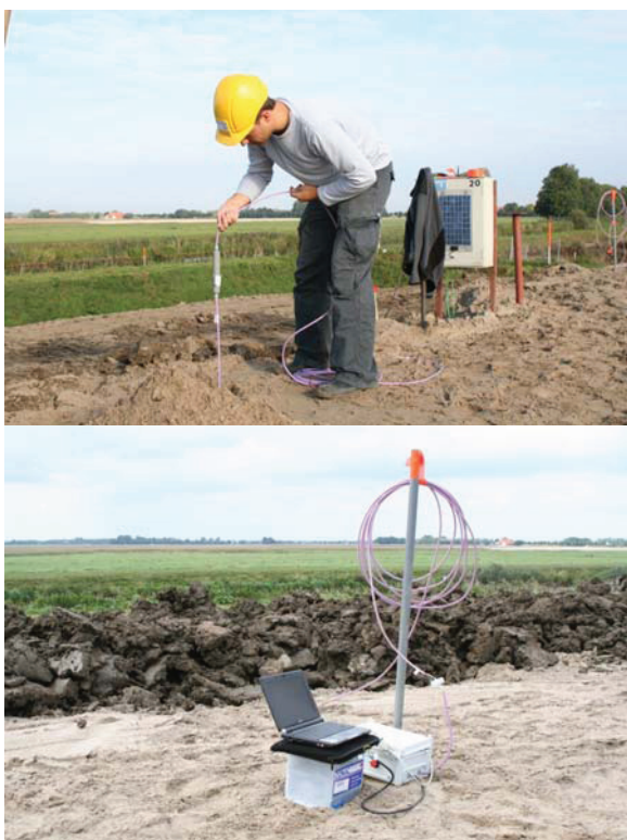
Figuur 5.1.3 a) Installatie en Foto 1b) directe uitlezing van verticale ketens.
