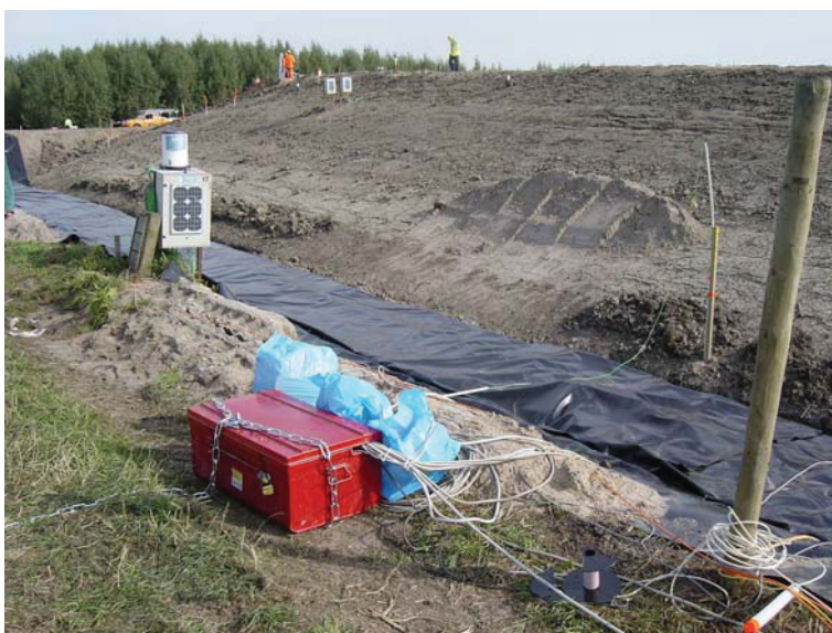
Afbeelding 9 Centraal punt van de meetleidingen op de kanaaldijk
