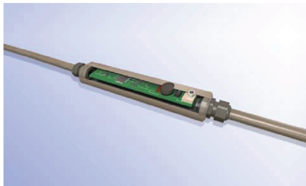
Figuur 5.1.1 Doorsnede van een GeoBeads sensormodule zoals toegepast in het meetnetwerk voor het IJkdijk Macrostabiliteitsexperiment met daarin sensoren voor waterspanning, temperatuur, beweging en vochtgehalte.
