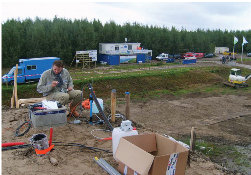
Figuur 3.5 Aansluiten van instrumentatie bovenop de dijk, halverwege september 2008
