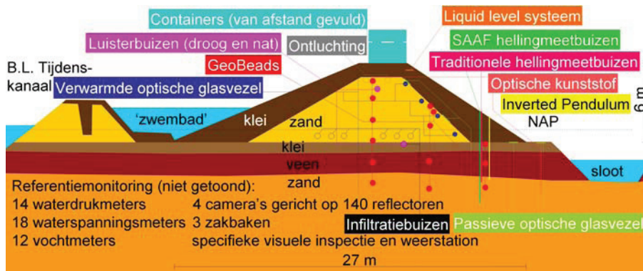
Figuur 3.3 Dwarsdoorsnede definitieve ontwerp stabiliteitsdijk inclusief instrumentatie
