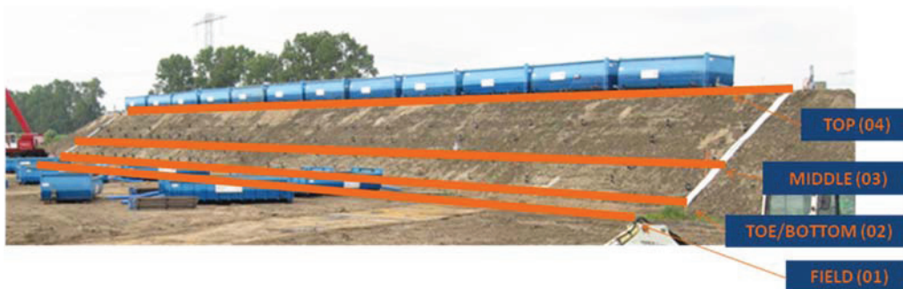
Figuur 5.10.7 Stabiliteitsdijk met indicatie van de locatie van alle strips.
