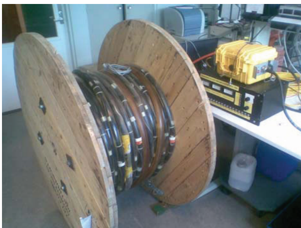
Figuur 5.8.6 Array met hydrofoons gewikkeld op een klos en luidspreker type UW30.
