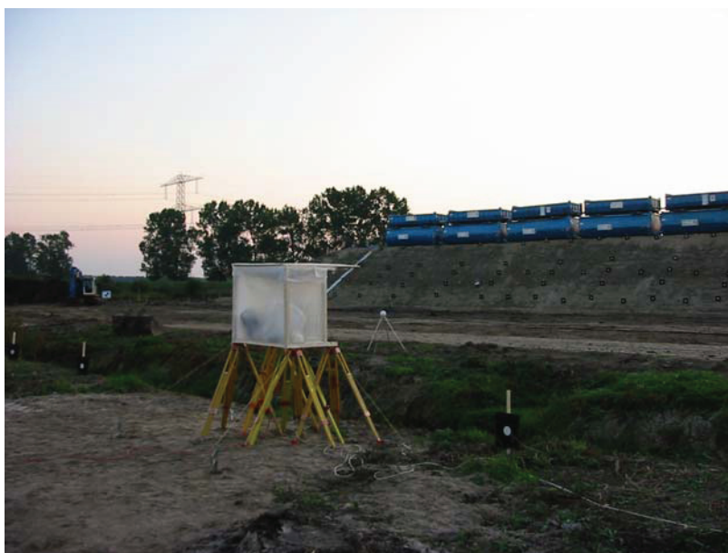
Figuur 5 Opstelling terrestrische laserscanner ScanStation 2. De scanner is geplaatst onder een afdak geïnstalleerd op vier driepoten. Het afdak bood bescherming tegen regenval, wind, vocht en invallend zonlicht.
