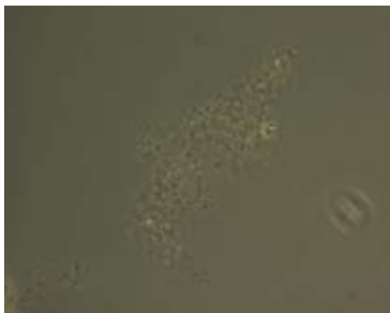
AFBEELDING 3.4 ALUMINIUMVLOK, \pm 100 \times 50 \mu\text{M}
