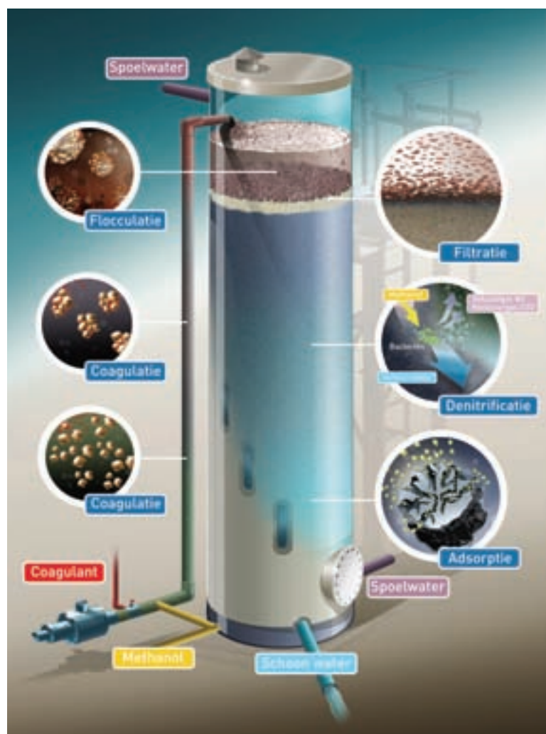
AFBEELDING 2 DEELPROCESSEN IN HET 1-STEP® FILTER
