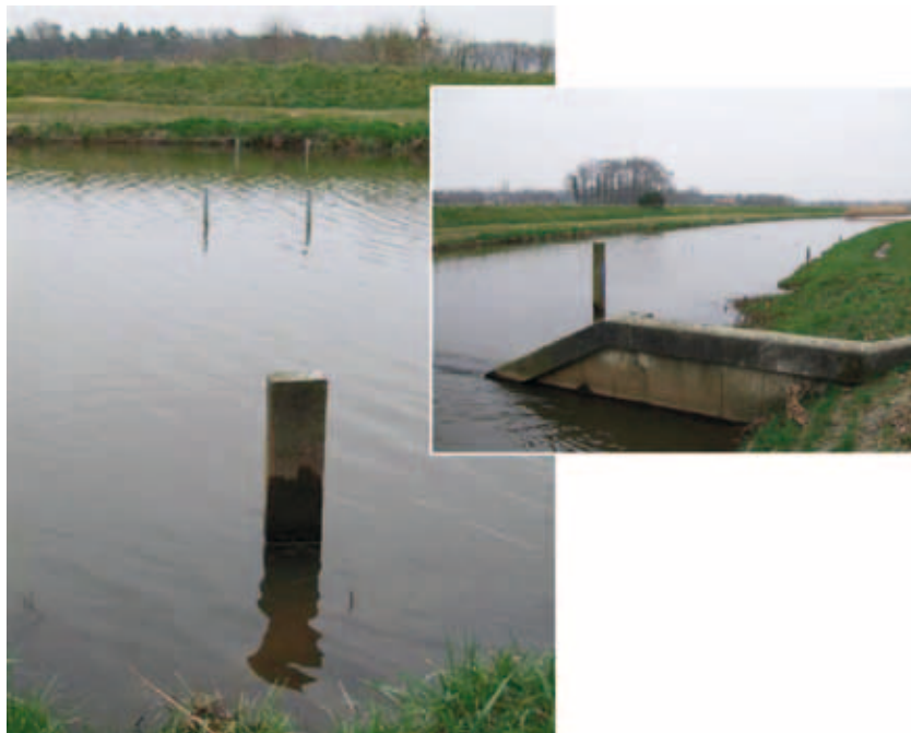
VASTE MEETOPSTELLING ADM LEBBENBRUGGE (FOTO: WS RIJN EN IJSSEL)
