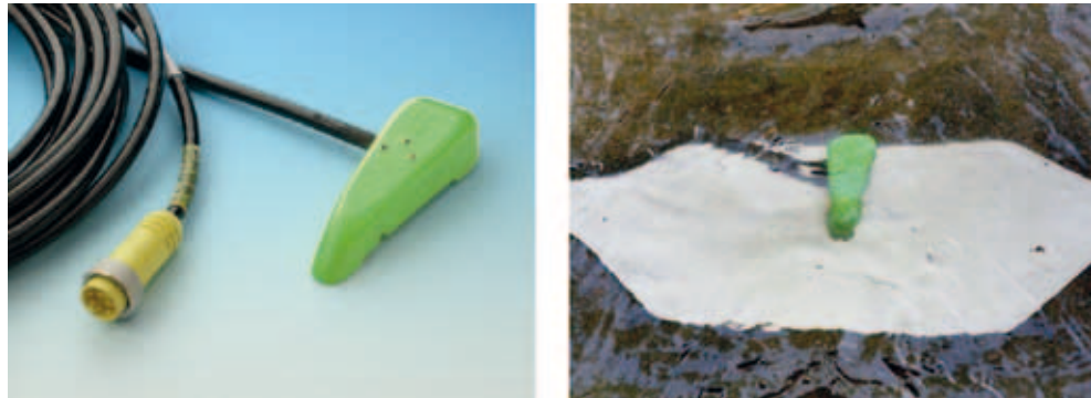
VOORBEELDEN VAN ELEKTROMAGNETISCHE MEETINSTRUMENTEN (FOTO'S FLOW-TRONIC)
