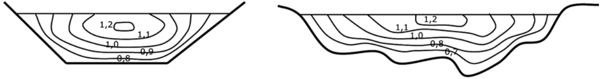
FIGUUR 5-3 VORBEELDEN AFHANKELIJKHEID SNELHEIDSVERDELING VAN VORM DWARSPROFIEL
