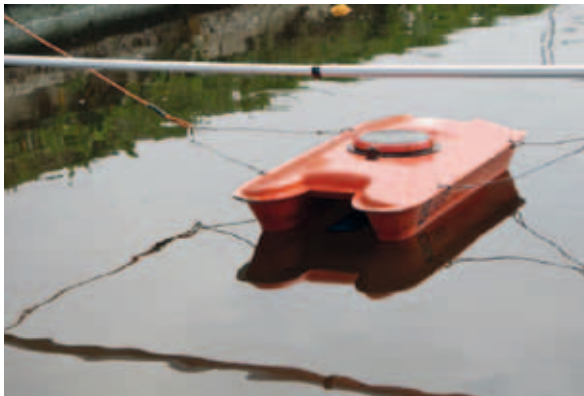
FOTO 5-7 METING IN EEN RAAI MET KABELLIJN EN ADCP T.B.V. CAPACITEITSMETING OPVOERGEMAAL LEEK (FOTO: WS NOORDERZIJLVEST)
