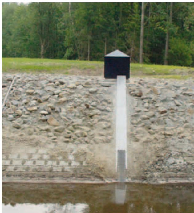
FOTO 6-22 BEWEEGBARE H-ADCP IN DE DINKEL (FOTO'S: WS REGGE EN DINKEL)
