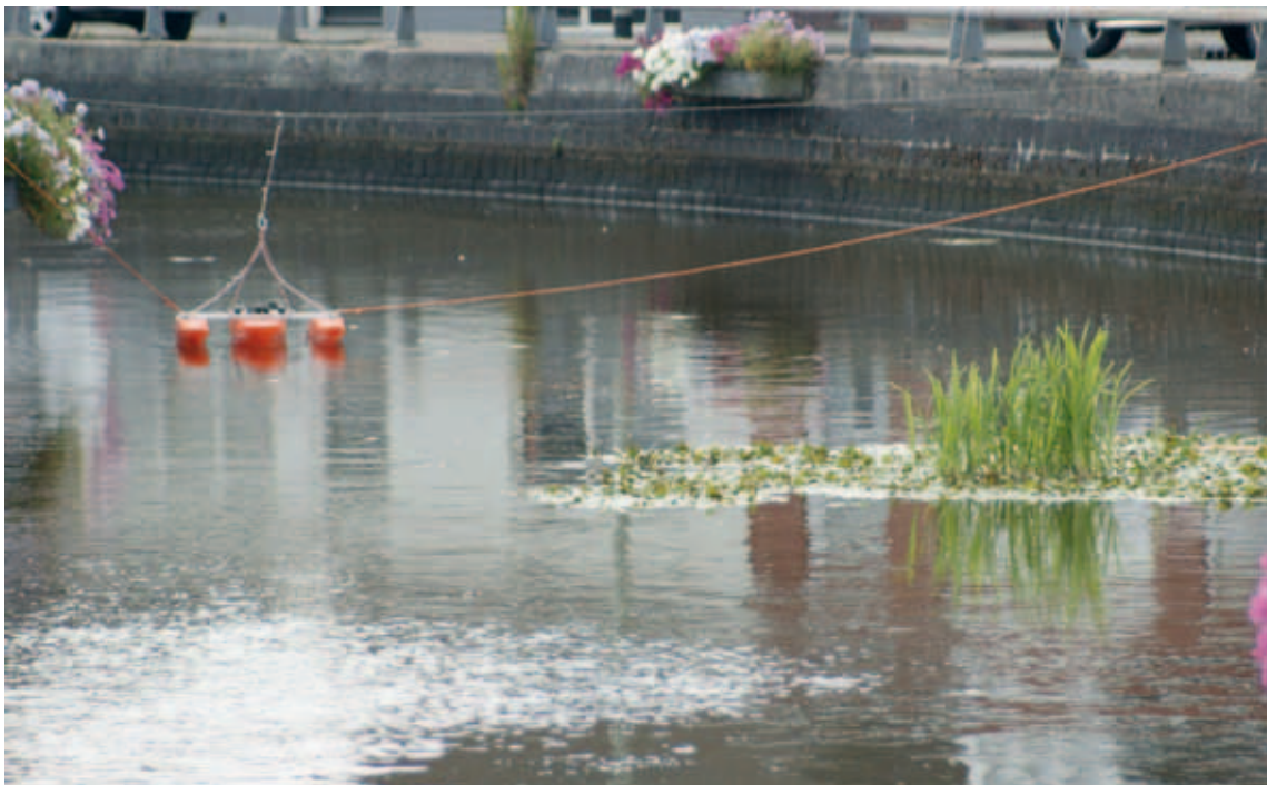
FOTO 5-7 METING IN EEN RAAI MET KABELLIJN EN ADCP T.B.V. CAPACITEITSMETING OPVOERGEMAAL LEEK (FOTO: WS NOORDERZIJLVEST)
