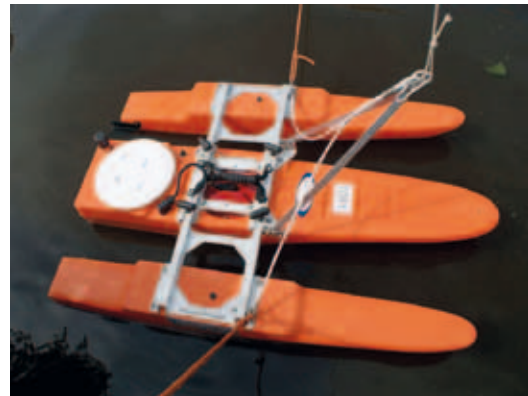
FOTO 5-7 METING IN EEN RAAI MET KABELLIJN EN ADCP T.B.V. CAPACITEITSMETING OPVOERGEMAAL LEEK (FOTO: WS NOORDERZIJLVEST)
