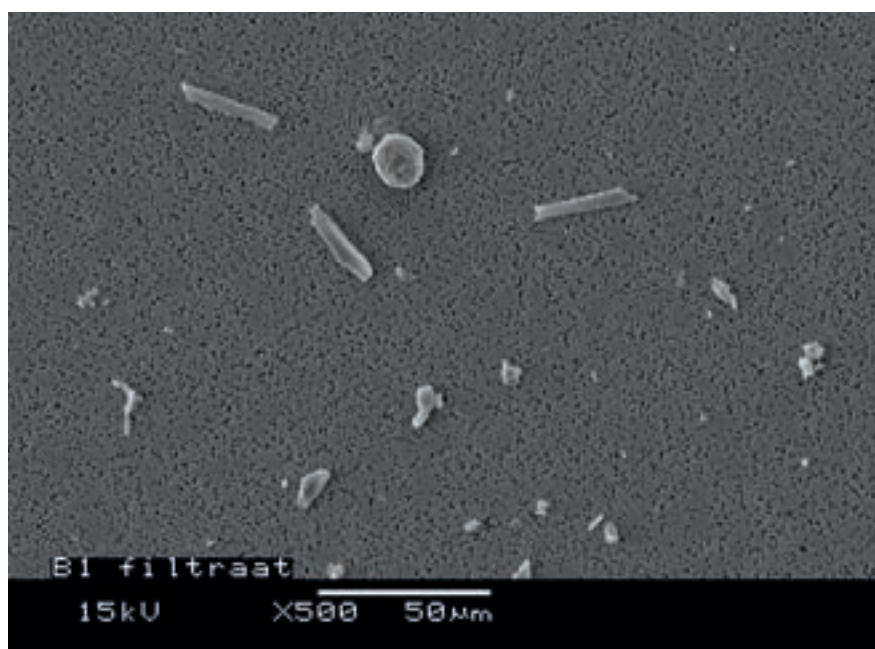
AFBEELDING B5.3B SEM OPNAME (500 X) VAN FILTRAAT BEWEGEND ZANDBED, IN MEESTROOM MODUS
