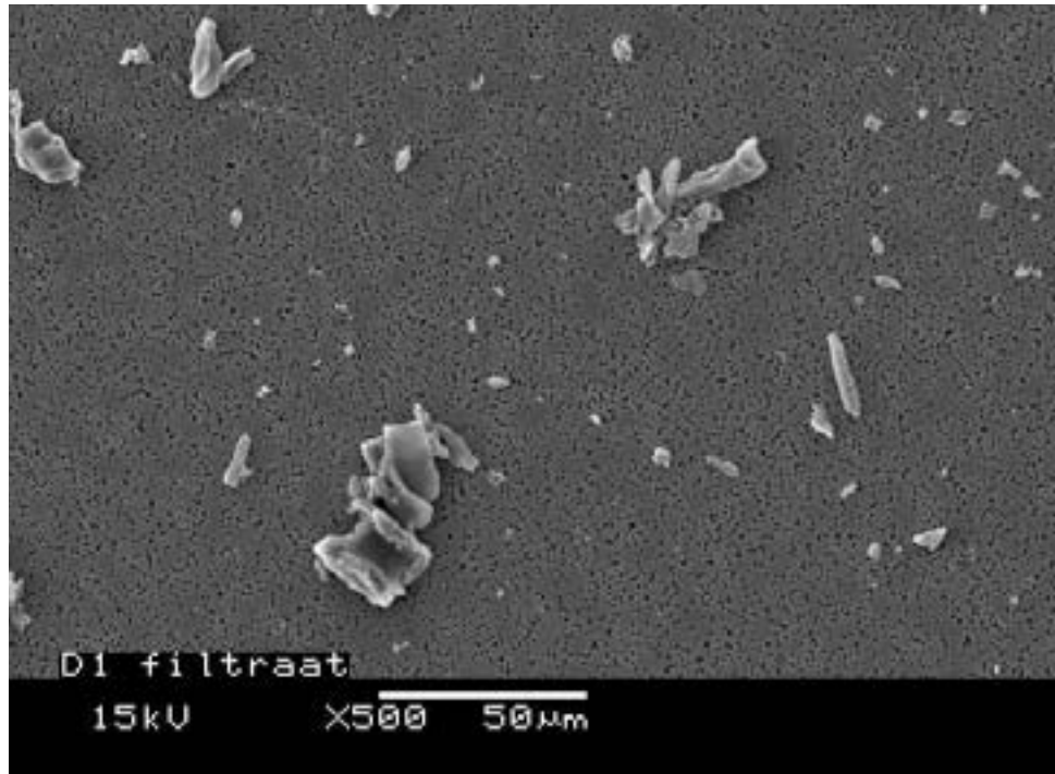
AFBEELDING B5.3C SEM OPNAME (500 X) VAN FILTRAAT STILSTAAND ZANDBED, IN TEGENSTROOM (BBA) MODUS
