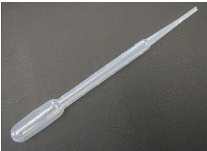
Fig 1 Een kunststof 'pasteur'pipet met grove maatverdeling
