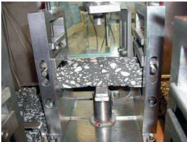
BEZWIJKEN VAN EEN PROEFSTUK IN DE DRIEPUNTS-BUIGOPSTELLING
