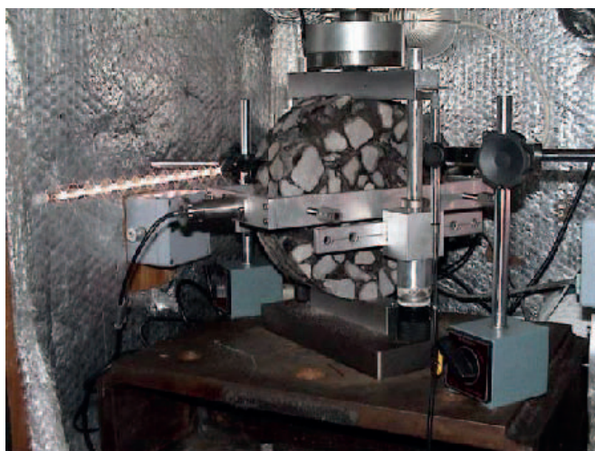
SCHIJF VAN OPEN STEENASFALT IN DE ITT-PROEFOPSTELLING
