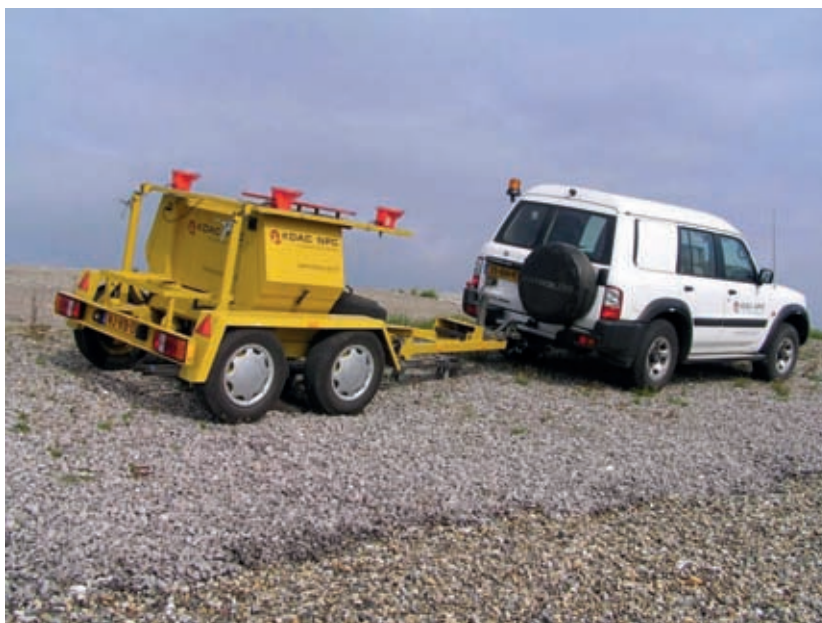
VALGEWICHT-DEFLECTIEMETING OP EEN TALUD OP EEN BEKLEDING VAN OPEN STEENASFALT
