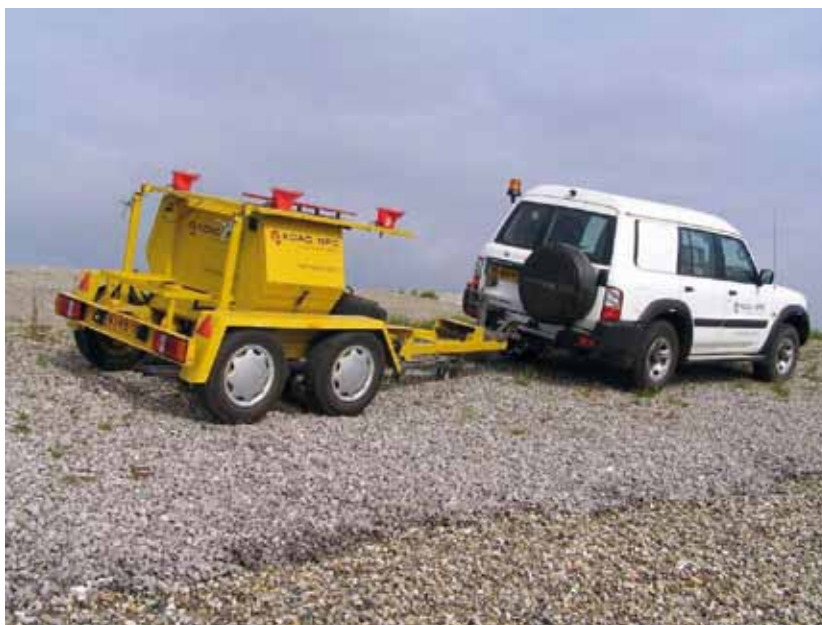
VALGEWICHT-DEFLECTIEMETING OP EEN TALUD OP EEN BEKLEDING VAN OPEN STEENASFALT
