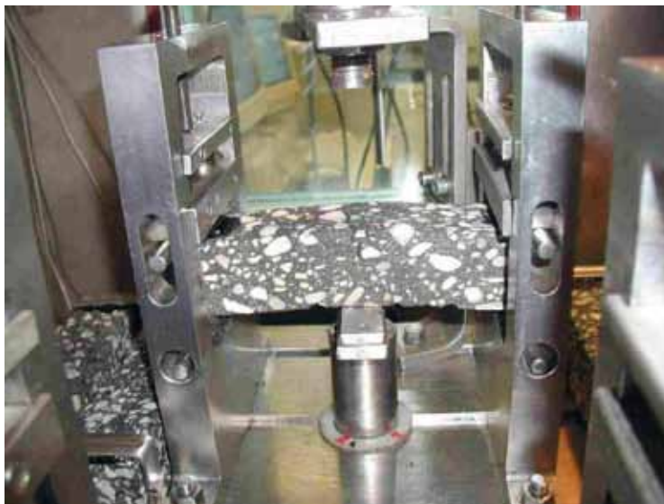
BEZWIJKEN VAN EEN PROEFSTUK IN DE DRIEPUNTS-BUIGOPSTELLING
