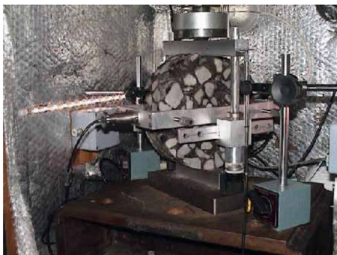
SCHIJF VAN OPEN STEENASFALT IN DE ITT-PROEFOPSTELLING
