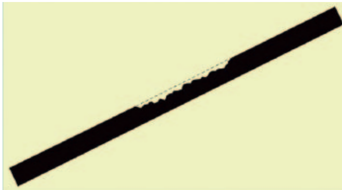
DWARSDOORSNEDE ASFALTBEKLEDING MET AANGETAST OPPERVLAK
