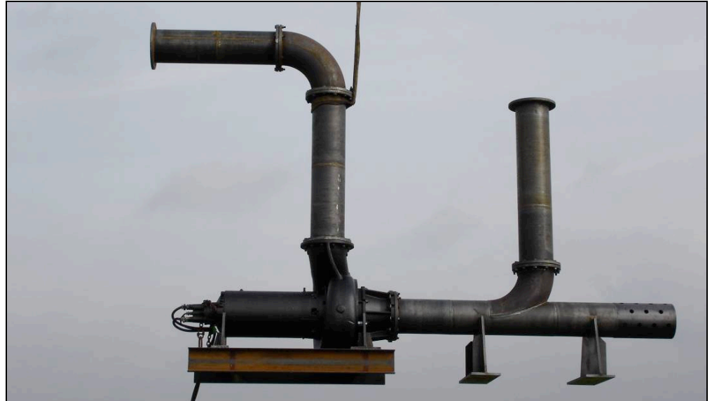
figuur 3.1 Hidrostal in testopstelling
