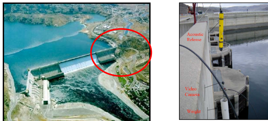
figuur 2.1.4 Grand Coulee Dam en pompstation (rood omcirkelt) Installatie om Sensor Fish los te laten.
