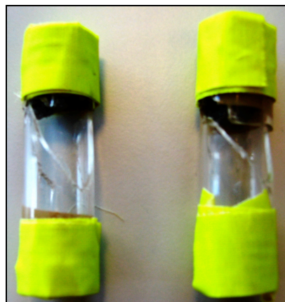
figuur 2.2.2 Voorbeeld van 2 kapot geslagen dummy exemplaren na passage door een opvoerwerk.
