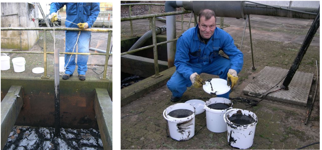
Figuur 2-5. Foto's van de monsterring van het slib in de slibbuffer van de AWZI.
