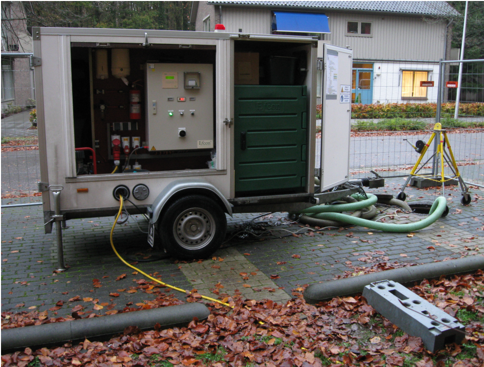
Figuur 2-2. Afbeelding van de mobiele monsterkast voor de monstername op monsterlocatie bij de GGZ instelling.
