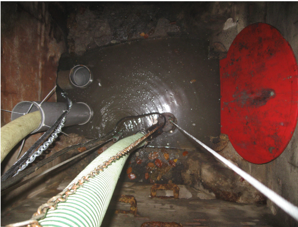
Figuur 2-3. Afbeelding van de monstername bij het riool van de GGZ instelling
