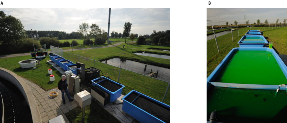
AFBEELDING 3.7 KLEURING DOOR URANINE DIRECT NA MENGING (A) EN NA VOLLEDIGE MENGING DOOR ALLE MESOCOSMS (B)
