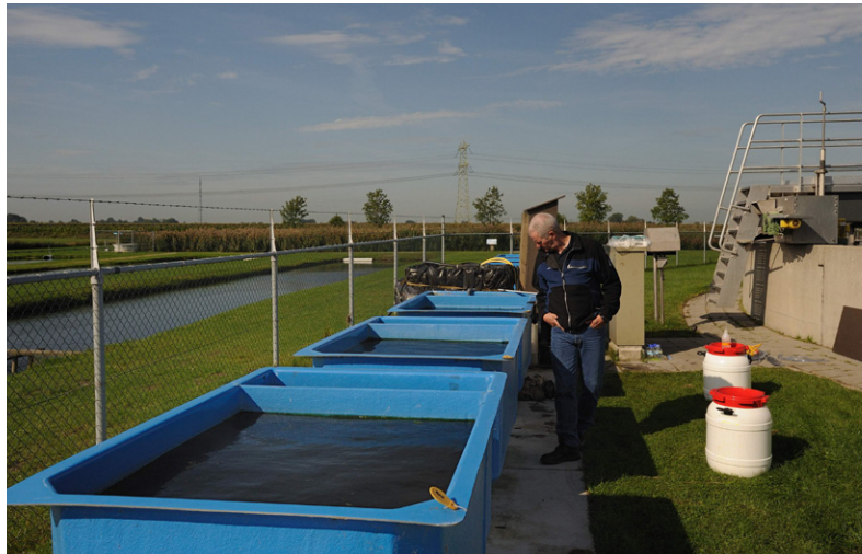
AFBEELDING 3.2 OPSTELLING MESOCOSM BIJ AQUALÂN, RWZI GROU
